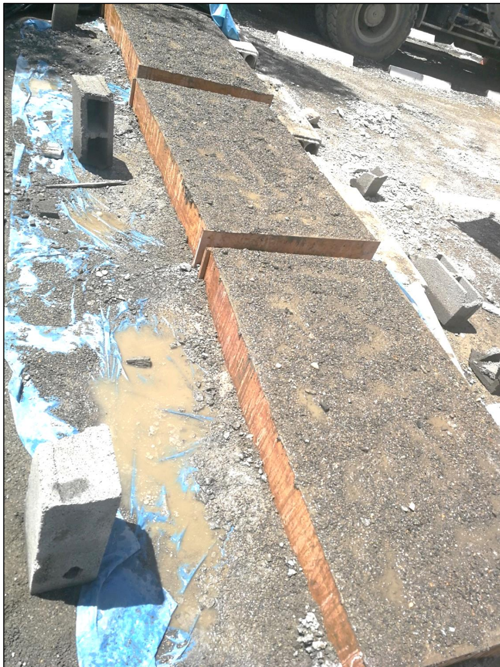
Figura N° 48. Curado de especímenes a través de “arroceras”
