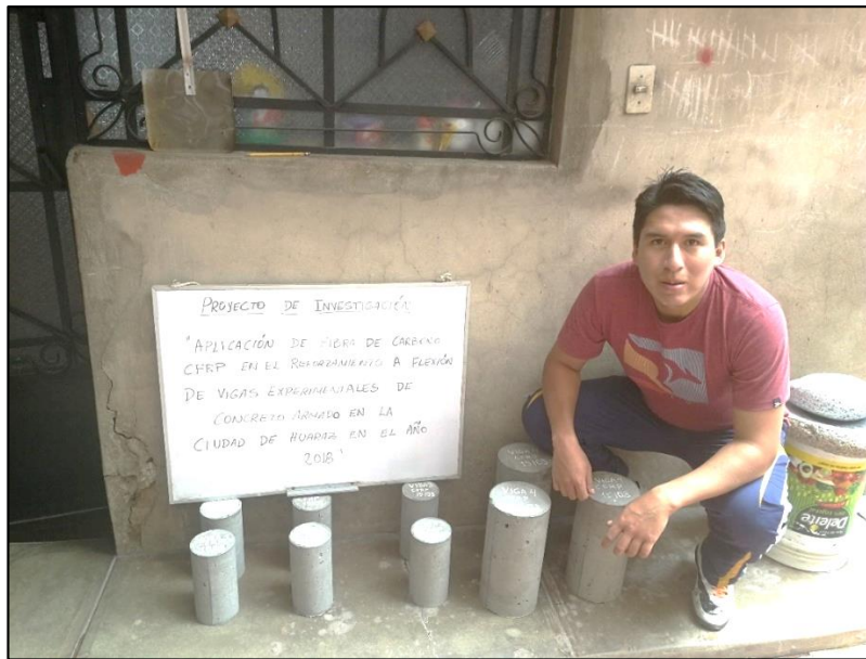
Figura N° 50. Probetas que serán ensayadas a los 28 días para determinar el f'_c
