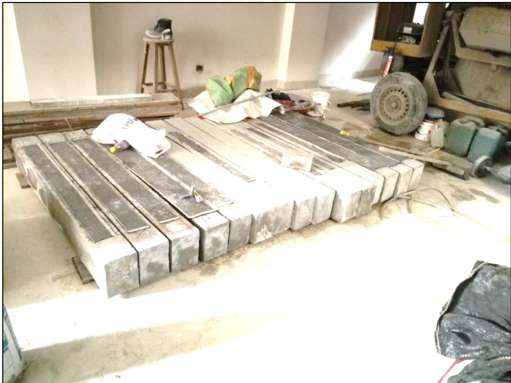
Figura N° 59. Vigas preparadas para su ensayo
