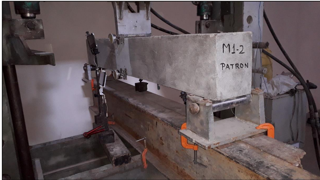
Figura N° 63. Montaje del ensayo, para viga patrón, se observan las cámaras que ayudarán a medir las deformaciones a través del tiempo de ensayo.
