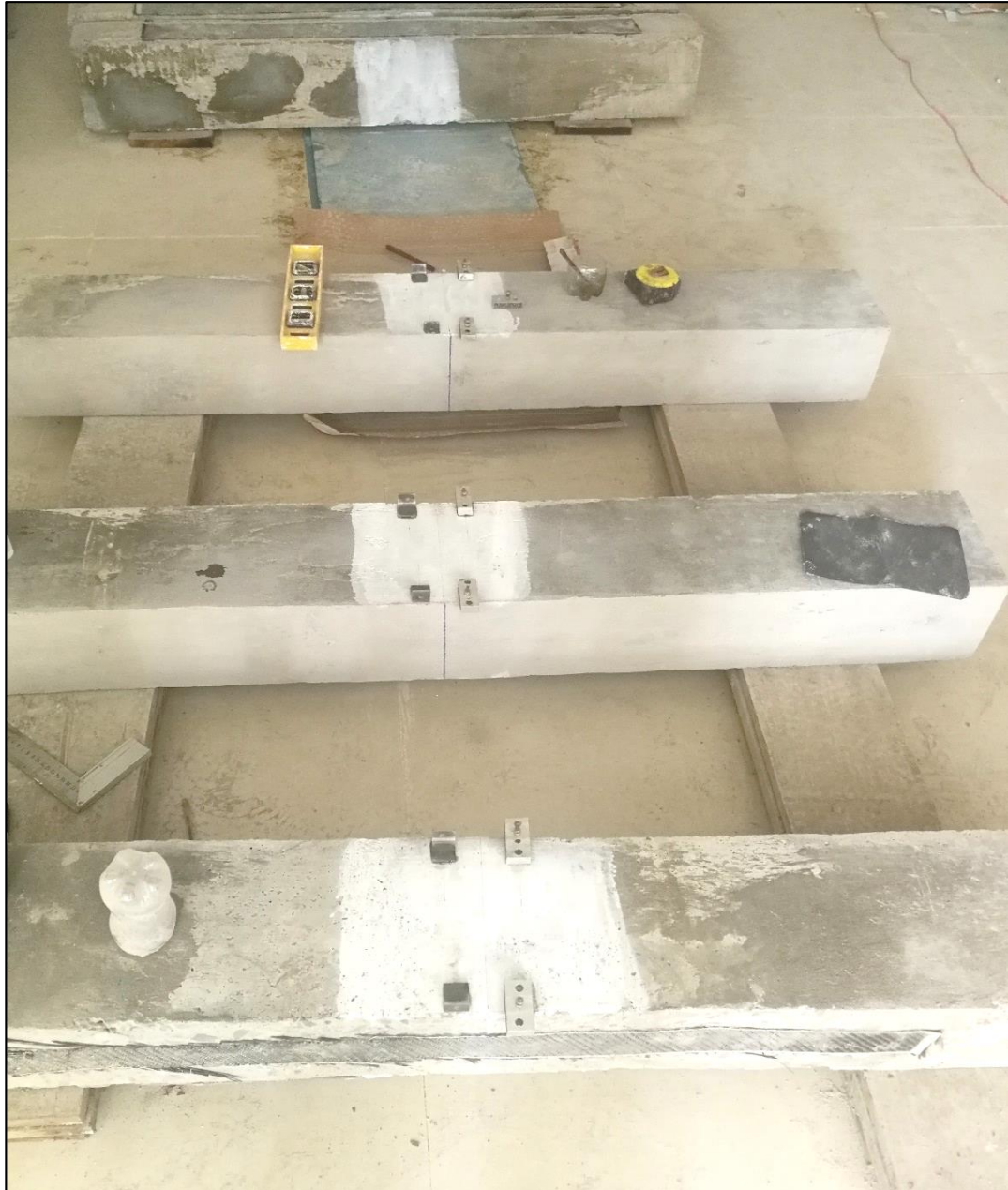
Figura N° 60. Aparatos para colocar deformímetros que medirán las deformaciones en la fibra superior e inferior.
