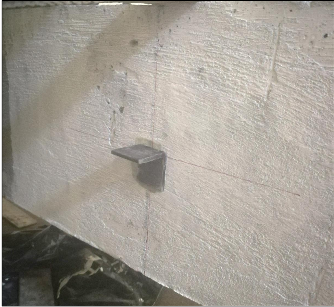
Figura N° 61. Aparatos para colocar vernier digital que medirá la deflexión
