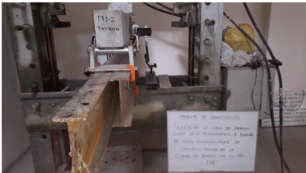
Figura N° 64. Ensayo de carga puntual aplicada en el centro, para una viga patrón.
