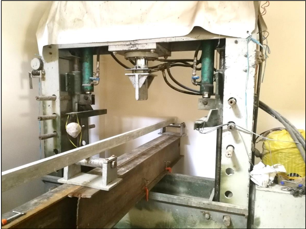
Figura N° 58. Máquina de ensayo universal preparada para recibir a las vigas
