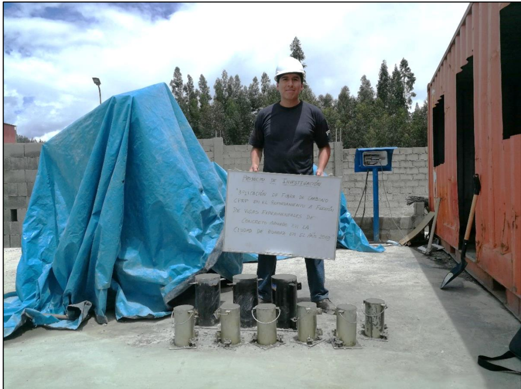
Figura N° 47. Elaboración de probetas para obtener el f_c
