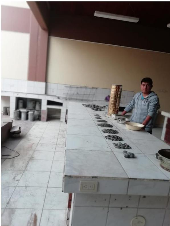
Figura 48. *Tamizado - Análisis granulométrico en laboratorio.*
