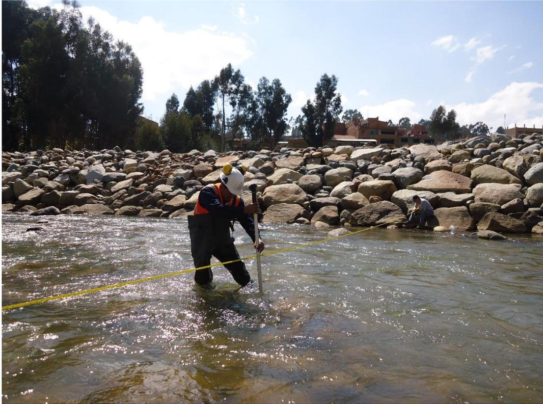
Figura 41. *Aforo de caudal en la sección transversal de río.*
