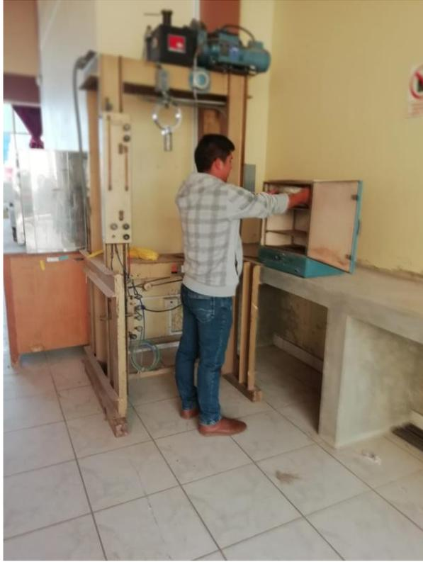
Figura 47. *Secado de muestra - Análisis granulométrico en laboratorio.*
