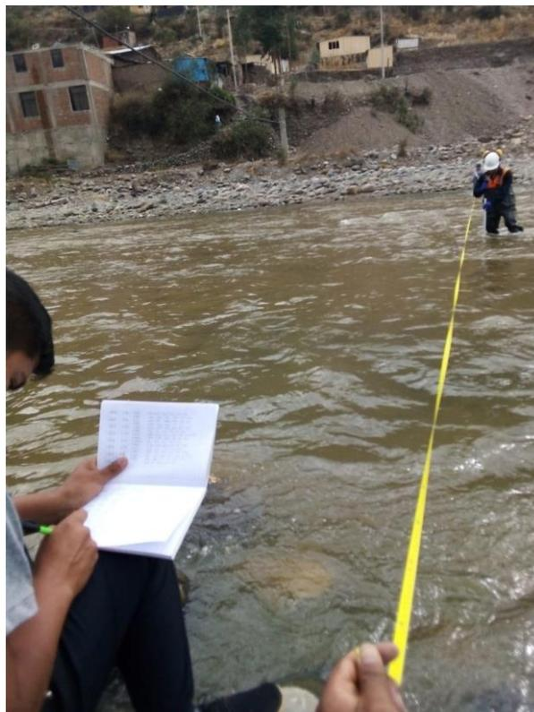
Figura 42. *Toma de datos de aforo de caudal.*
