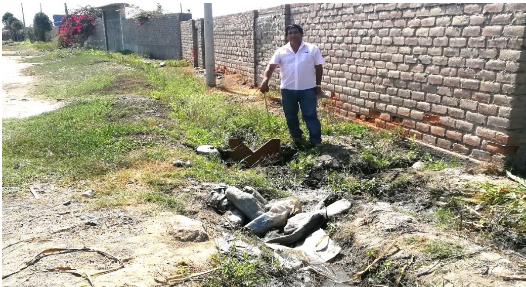
Figura 3. Aforador tipo vertedero Triangular, registrando ingreso de agua a la parcela experimental
