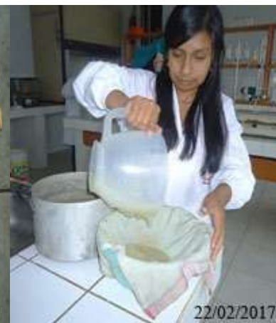
Imagen 03: Filtrado de la solución péctica
