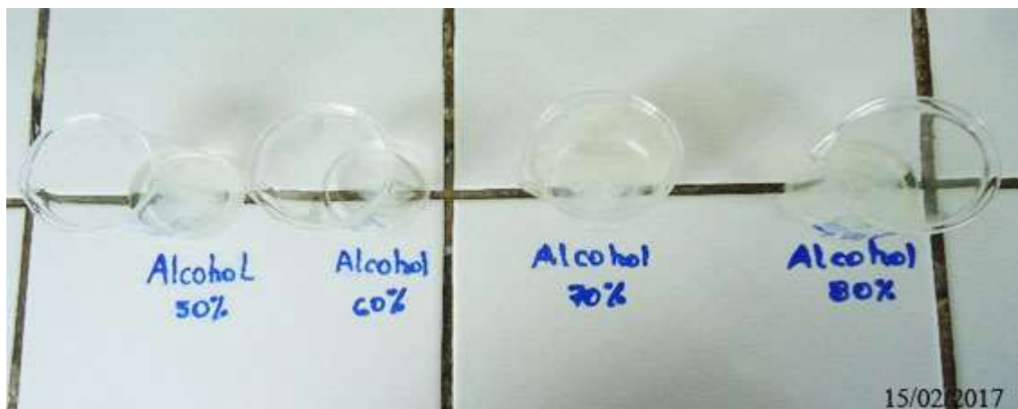
Imagen 04: Precipitación de la pectina usando diferentes porcentajes de alcohol acidulado
