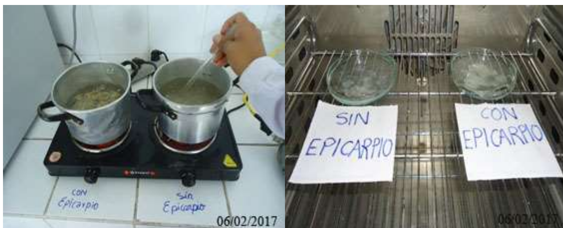
Imagen 01: Hidrólisis del albedo acondicionado con y sin epicarpio
