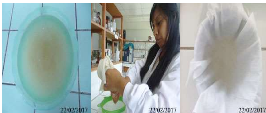
Imagen 05: Filtrado de la solución sobrenadante
