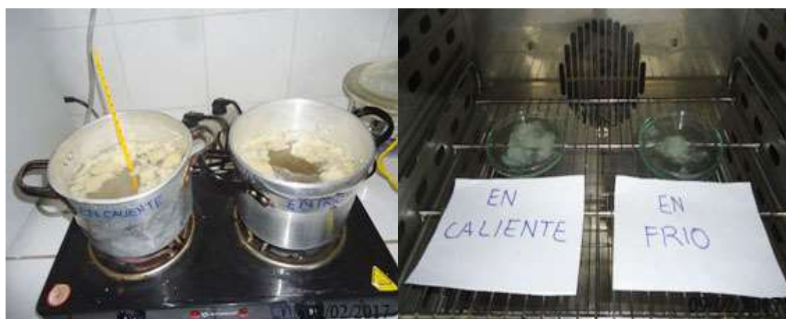
Imagen 03: Hidrólisis agregando el albedo en frío y caliente
