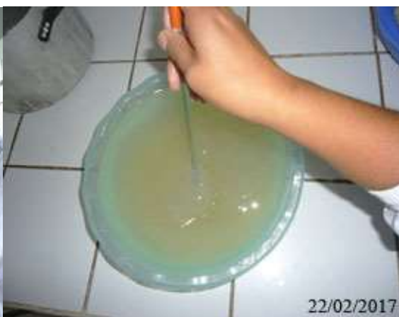
Imagen 04: Precipitado de la solución péctica
