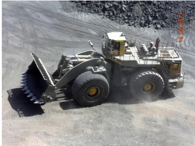
Fuente: San Martin FOTO N° 12. CARGADOR KOMATSU W A1200 SMCG MINA 05, SHOUGANG
