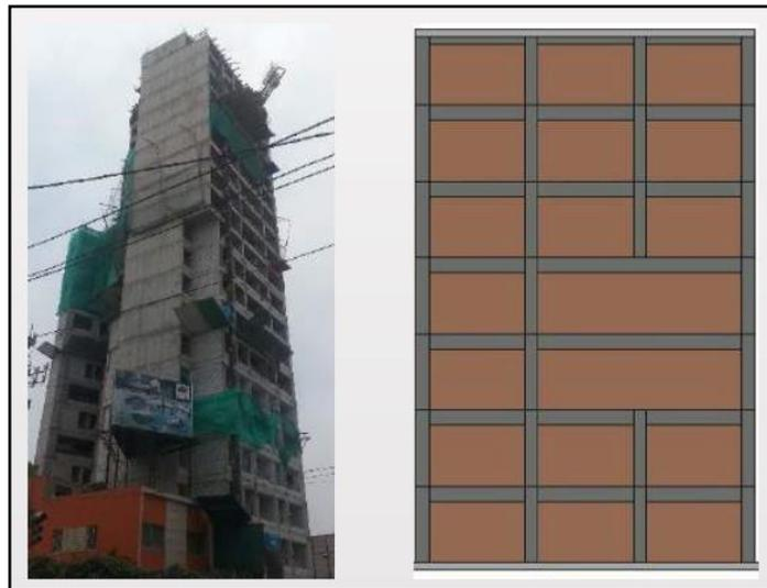
Figura 2.11 Discontinuidad en los Sistemas Resistentes
