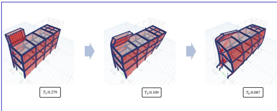
Figura 5.55 Principales modos de vibración
