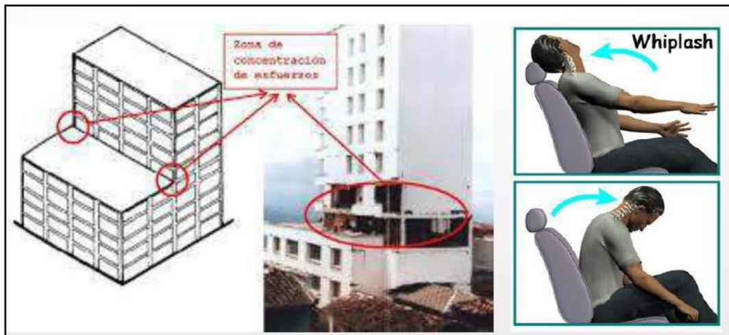
Figura 2.17 Daños en las estructuras debido a irregularidad geométrica vertical, en la vista Izquierda se aprecia la zona de concentración de esfuerzos y a la derecha se ve un ejemplo del efecto fenómeno de latigazo.
