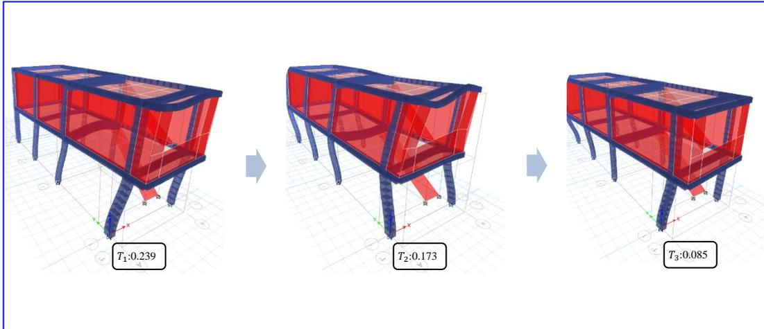
Figura 5.30 Principales modos de vibración
