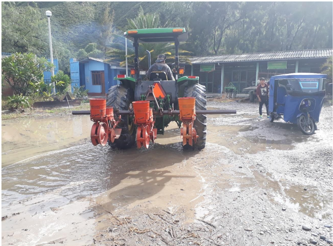
Fotografía N° 06: Tractor implementado con la sembradora listo para los ensayos
