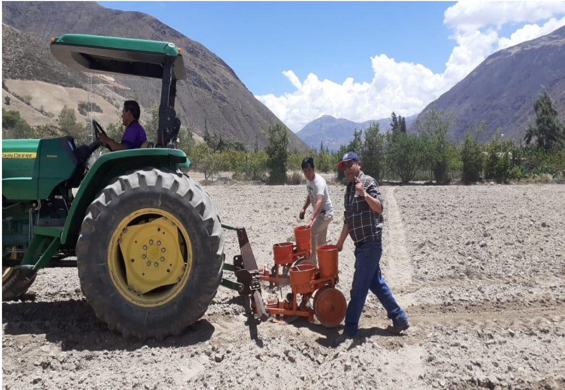
Fotografía N° 07: Prueba de funcionamiento de la sembradora de precisión antes de la calibración
