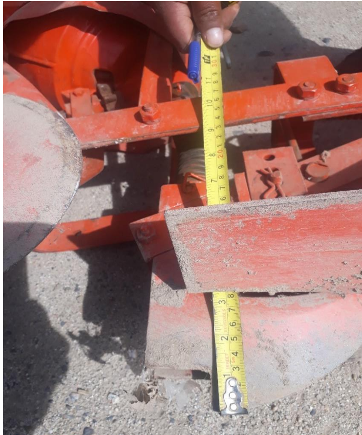
Fotografía N° 09: Calibración de la sembradora (Profundidad teórica y real de siembra)
