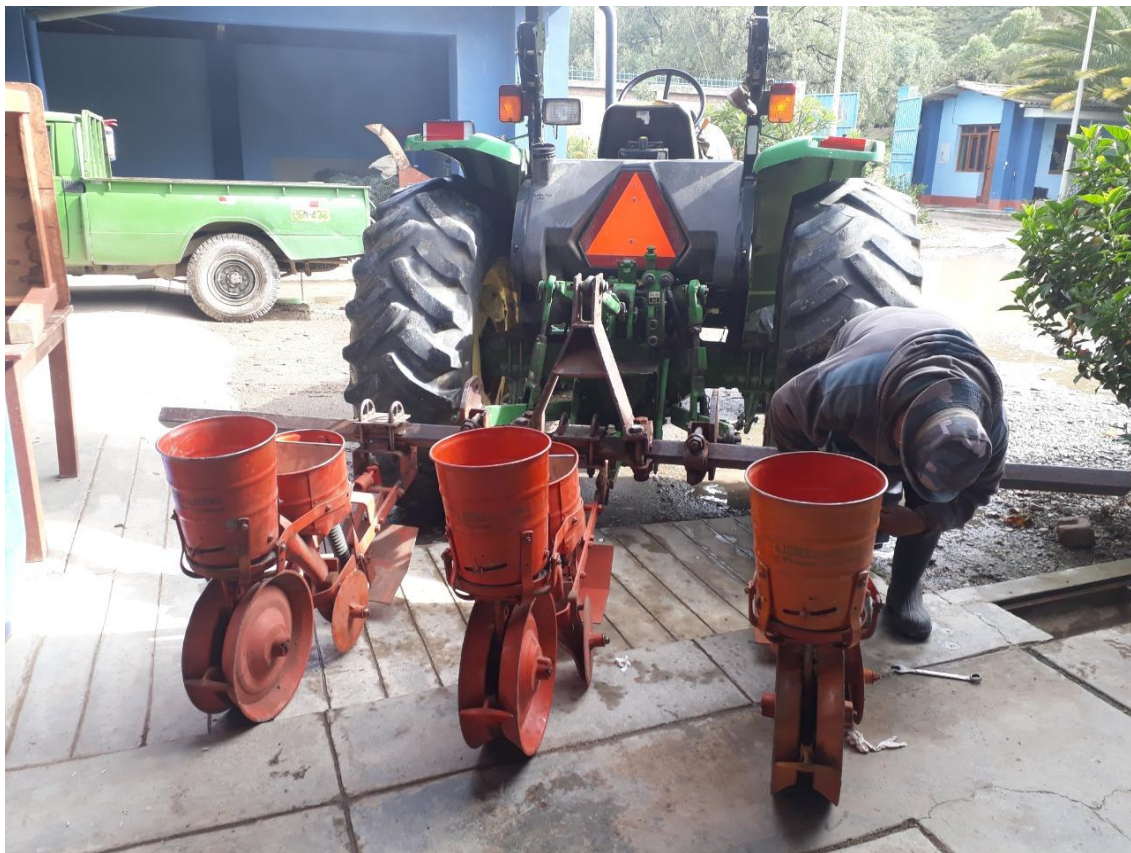
Fotografía N° 12: Calibración de la sembradora (Distancia entre surcos o líneas)
