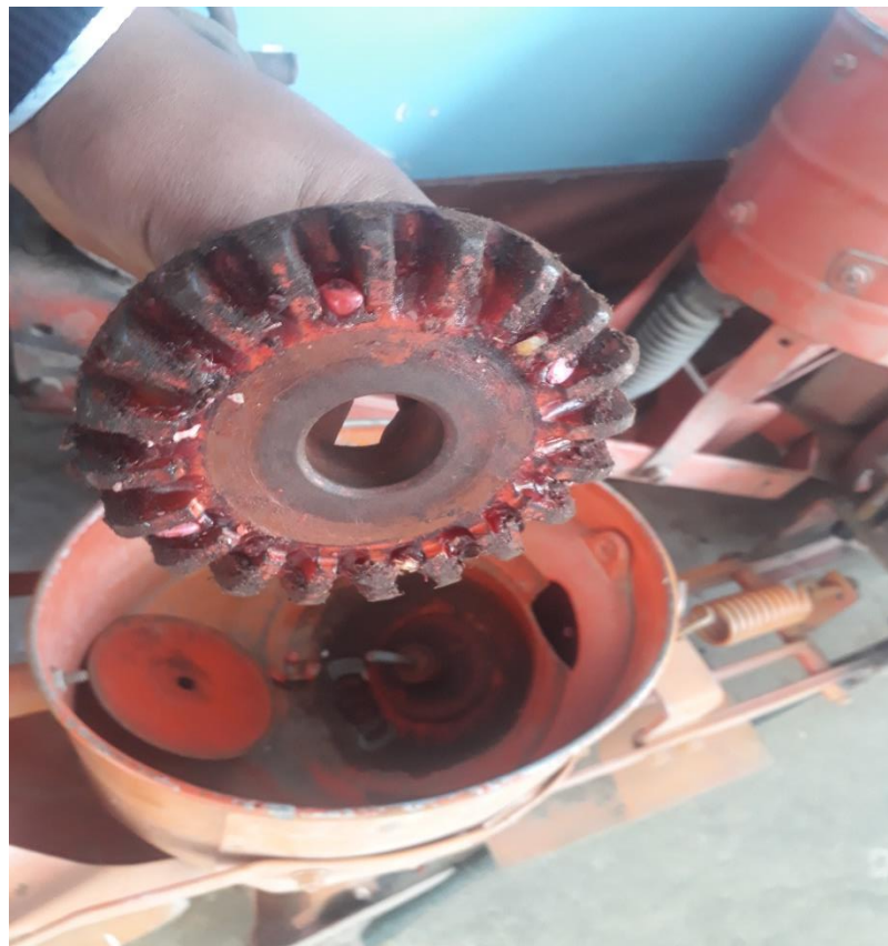
Fotografía N° 04: Limpieza y engrase de los elementos de transmisión
