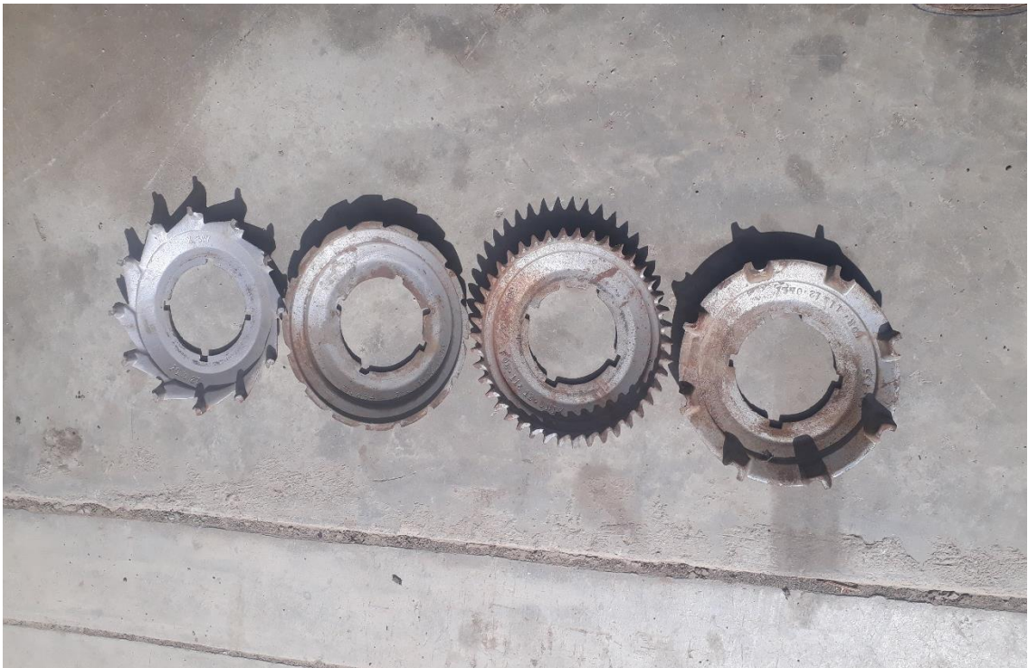
Fotografía N° 10: Platos distribuidores para calibración (Distancia teórica de siembra)
