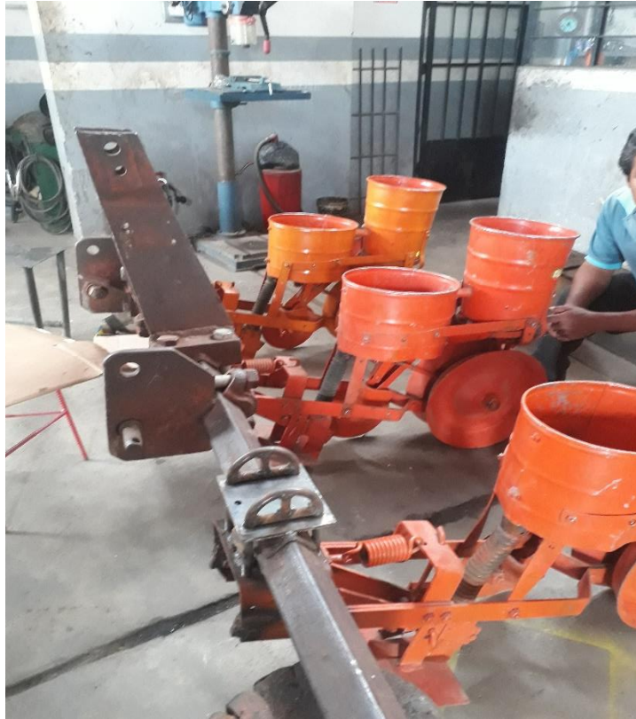
Fotografía N° 05: Adaptación de los cuerpos de la sembradora a la barra transversal del bastidor de la reja mediante abrazaderas la cual se mandó diseñar
