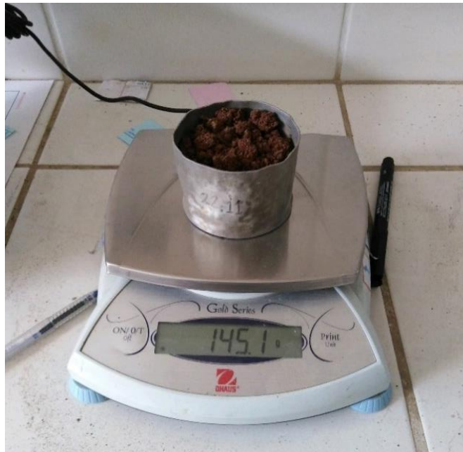
Figura 4. Peso de la muestra seca más el recipiente en la determinación del contenido de humedad.
