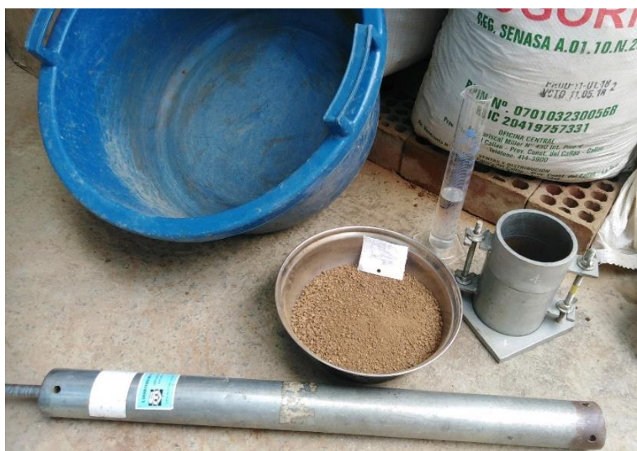
Figura 7. Instrumentos para el desarrollo del Ensayo de compactación con energía modificada.
