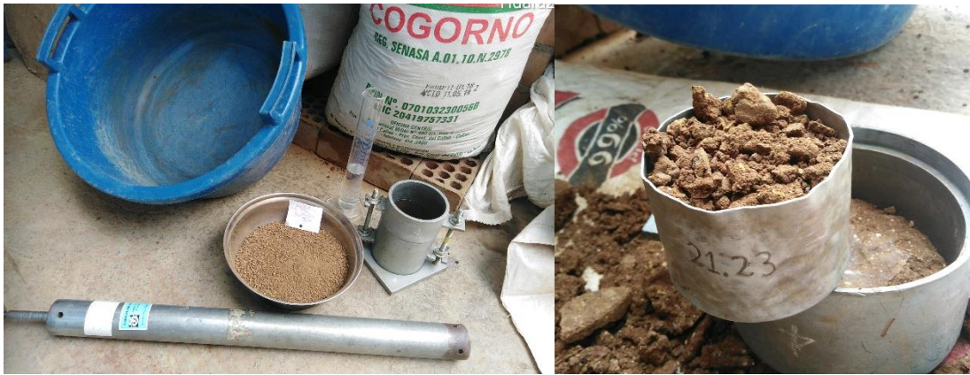
Ensayos de laboratorio, compactación de suelos en laboratorio utilizando una energía modificada.
