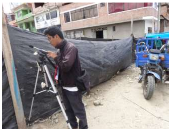
Figura N°8: Fotos de las mediciones del nivel de ruido por el especialista del laboratorio de Calidad Ambiental de la UNASAM.
