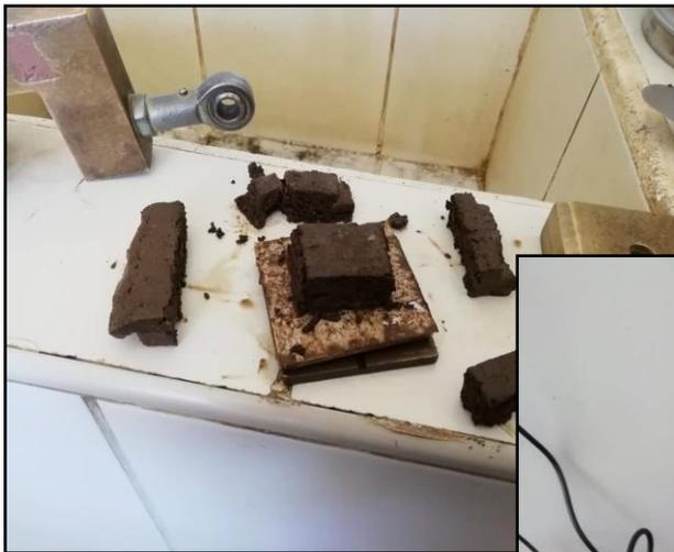
Fotografía 8 y 9: Se toma la humedad final con la cual a terminado la muestra, para determinar la grafica humedad con carga normal.
