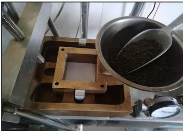
Fotografía 3: Se muestra la cantidad de suelo que se compactara para lograra el peso unitario para la cual se realizara el ensayo.
