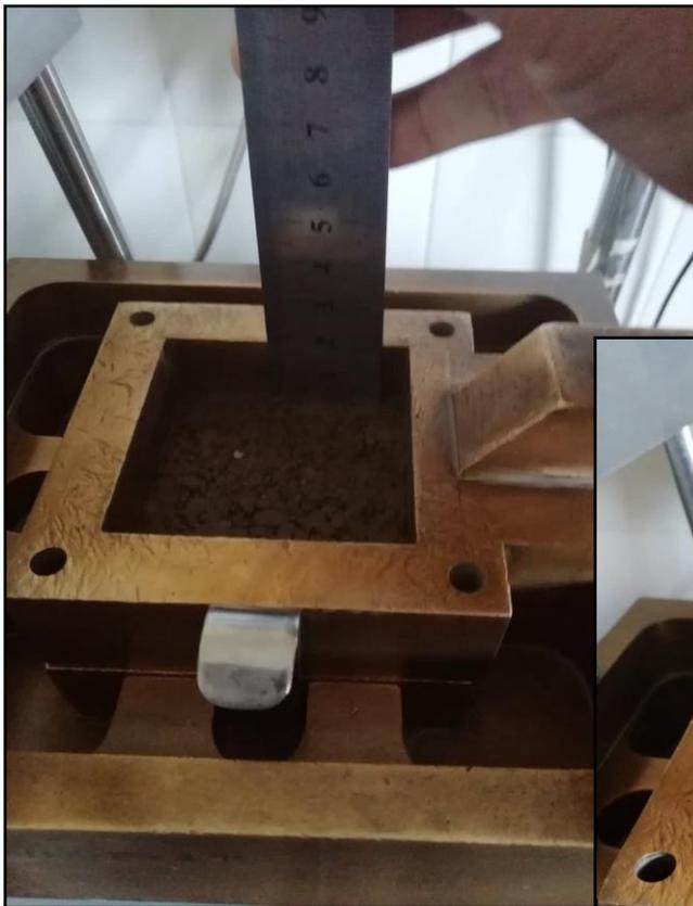
Fotografía 5 y 6: Muestran los controles que se toman para tener un espesor de 2cm para así no haya cambios en el peso unitario.
