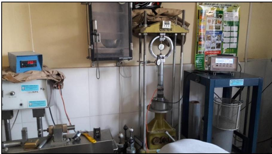
Fotografía 2: Se muestra la calibración del equipo de corte directo con la empresa ORION.
