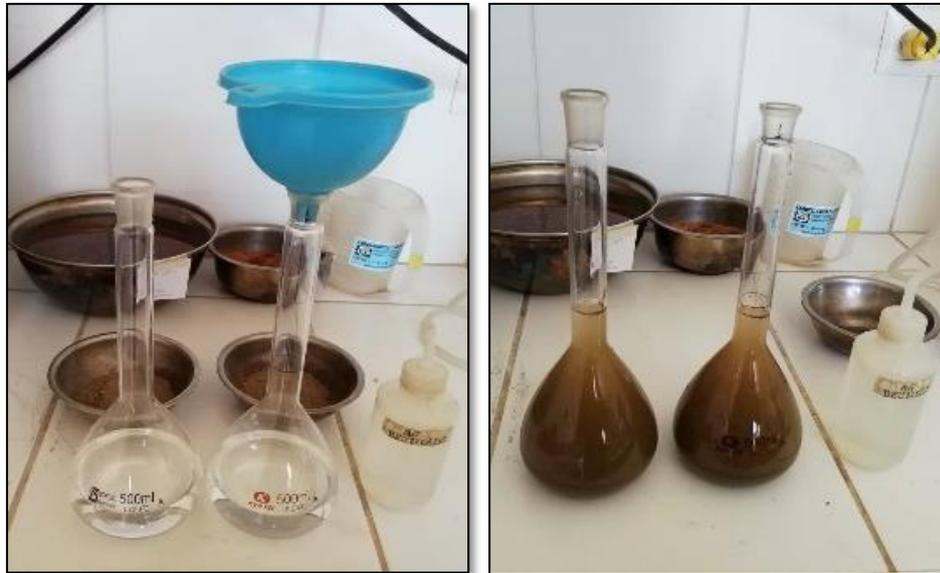
**Figura 42. Método de ensayo para determinar el peso específico relativo de las partículas sólidas de un suelo.**
