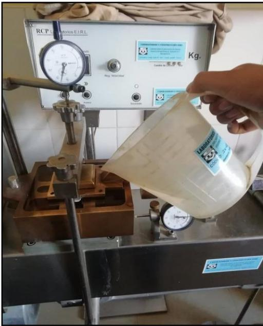
Fotografía 7: Se somete a la muestra a saturación para luego hacer las lecturas de deformación normal que dependera del grado de filtración y de la carga a la cual se somete la muestra.
