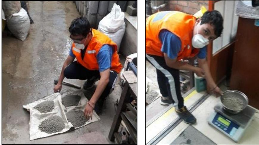
*Figura 37. Obtención en laboratorio de muestras representativas (Cuarteo)*
