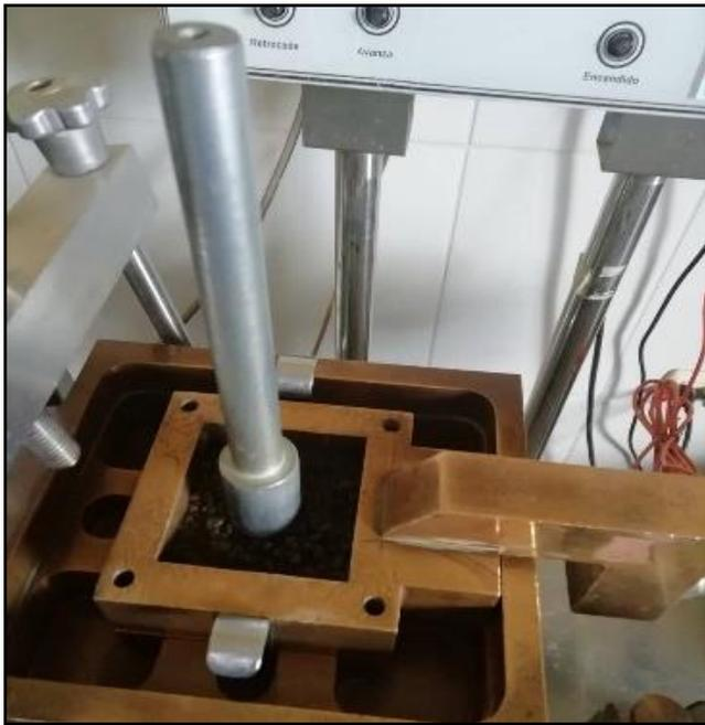
Fotografía 4: Se muestra la compactación de la muestra.
