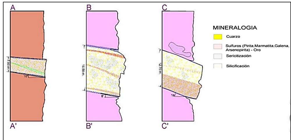
Imagen 12. Cortes Transversales Manto Carla Sofía / Texturas De Relleno
