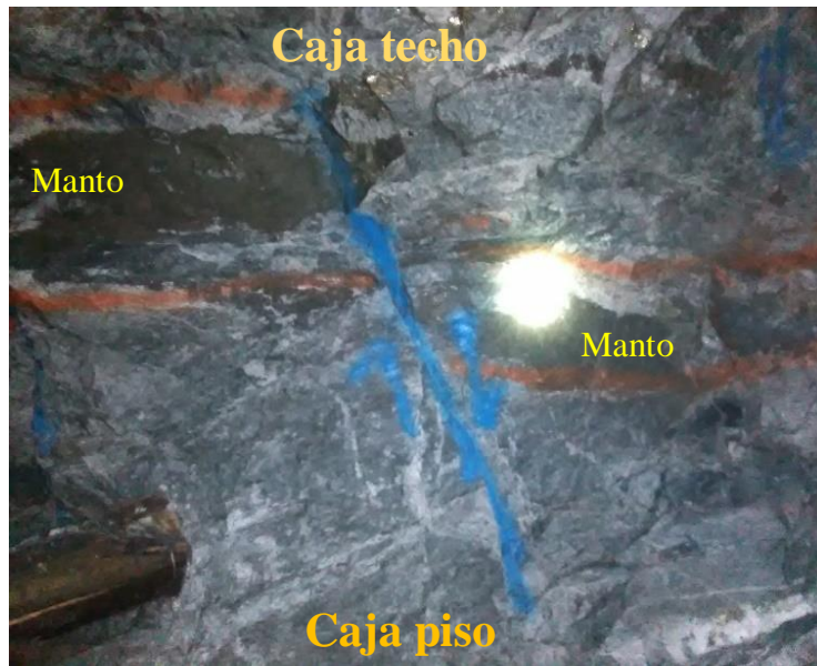
Imagen 13.falla normal desplazo al manto –TJ18 A
