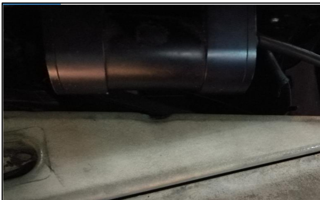
Foto 1: Vibrador Instalado en el Asiento de un Camión Minero.
