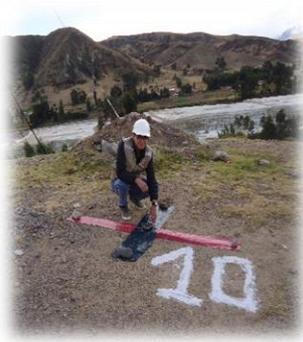
Fotografía 13: Marca del punto de control N° 10 para la fotografía con dron.
