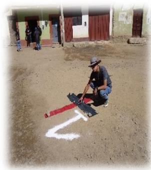
Fotografía 7: Marca del punto de control N° 1 para la fotografía con dron.
