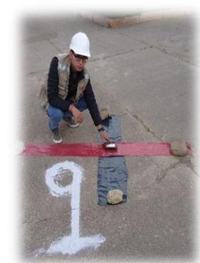
Fotografía 12: Marca del punto de control N° 9 para la fotografía con dron.
