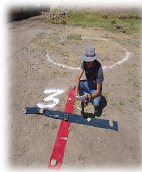
Fotografía 8: Marca del punto de control N° 3 para la fotografía con dron.
