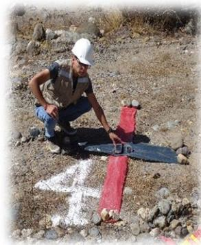
Fotografía 9: Marca del punto de control N° 4 para la fotografía con dron.
