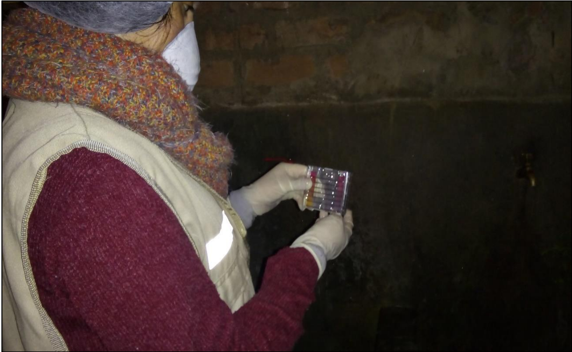
Foto N° 29: Medición del Cloro Residual en el punto CF
