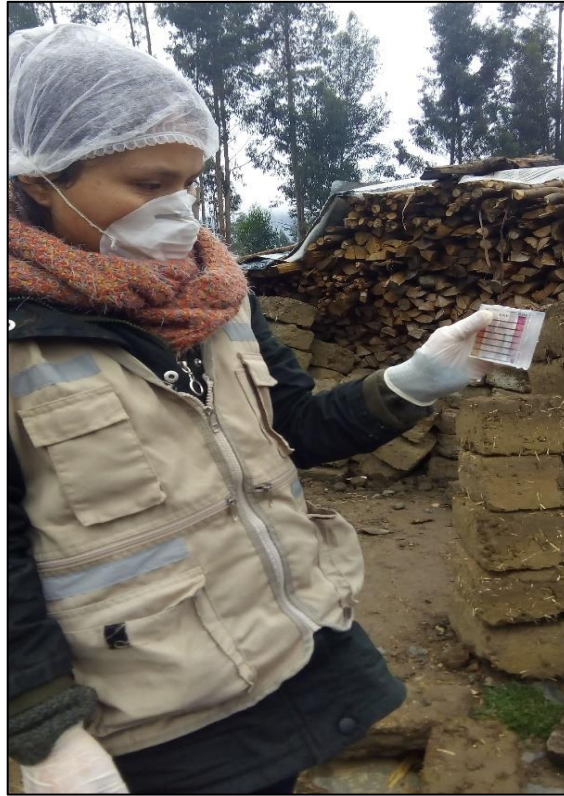
Foto N° 19: Medición de Cloro Residual en el punto CI
