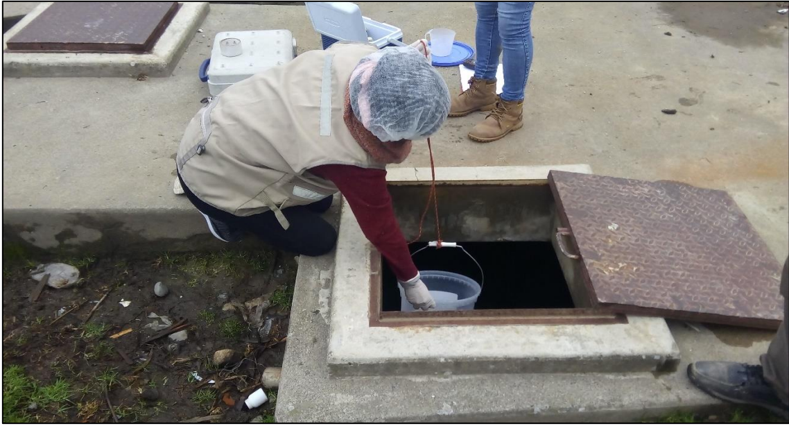
Foto N° 15: Toma de muestras en el Reservorio
