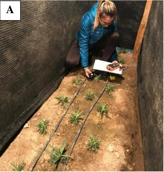
FOTOGRAFIA 8: (A) y (B) Medición de la intensidad lumínica con el uso del fotómetro, bajo la luz incandescente
