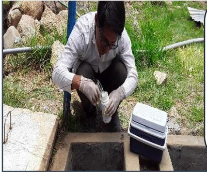
El análisis de los parámetros de estudio que son el Nitrógeno total, Fosforo total y nitratos se realizaron con los siguientes métodos (Digestión Koroleff, nitrospectral, Vanadatamolibdato y Nitrospectral) respectivamente.
