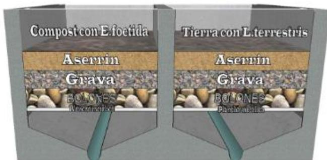
**DETALLE DE MEDIO FILTRANTES Y SISTEMA DE DRENAJE**
