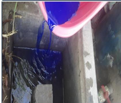
Para la evaluación del sistema se midieron los TRH para cada biofiltro usando un colorante para poder visualizar el tiempo que tarda en filtrarse el agua residual.
