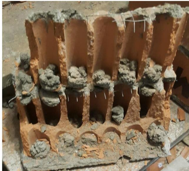
**Anexo 5.** Detalle de malla metálica posterior al ensayo.
