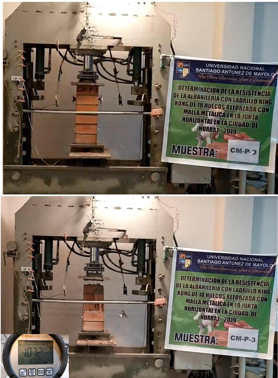
**Figura 6.8.** Arriba: Muestra CM-P-3 antes del ensayo; Abajo: Muestra CM-P-3 posterior al ensayo con su carga máxima.
