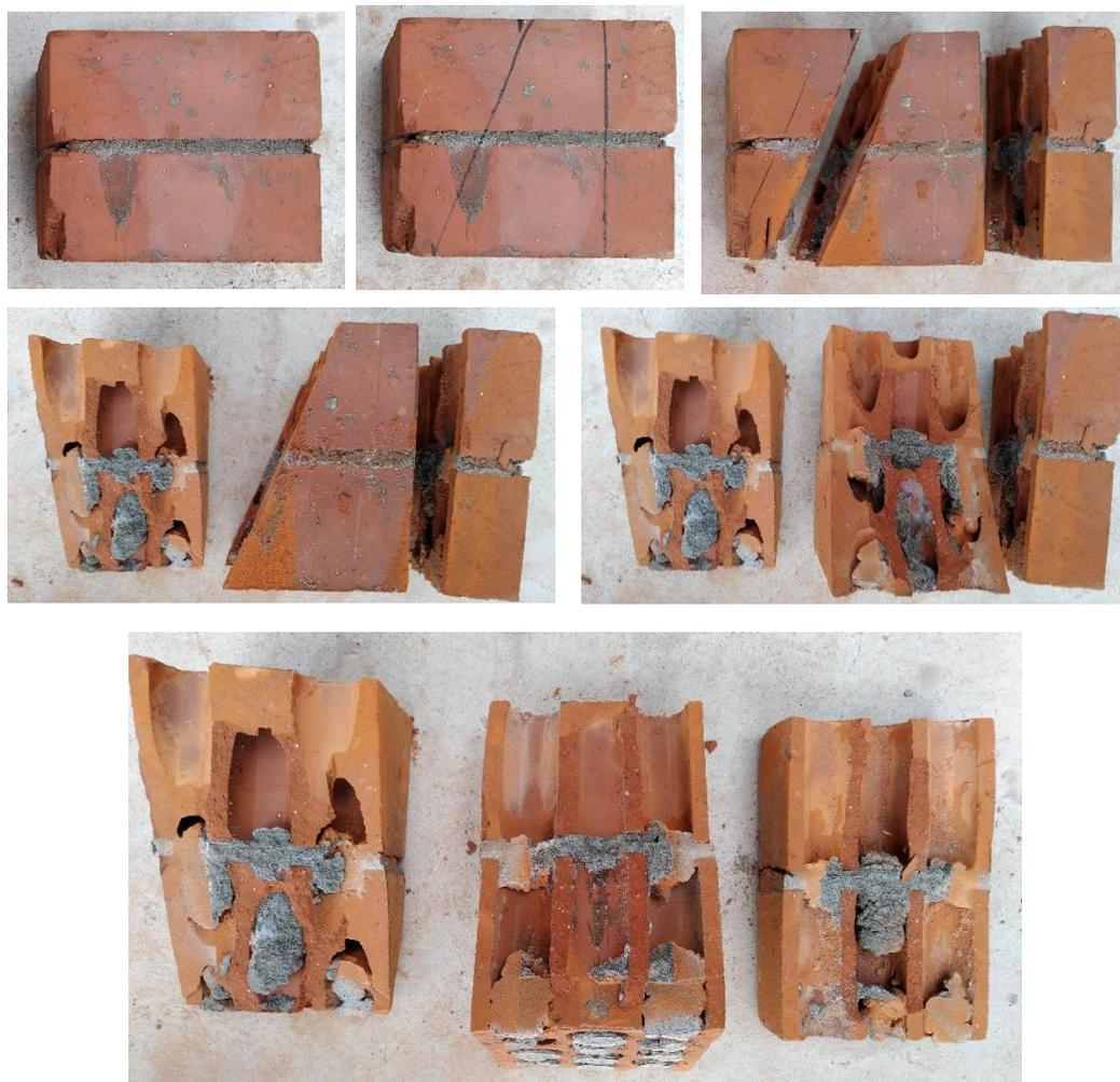
**Figura 3.2.** Superior: marcado y corte, Intermedio: vistas laterales, Inferior: vista interior de la traba.
