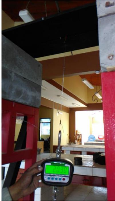
**Figura 3.6.** Ensayo a tracción de Malla electrosoldada Configuración de 1 Hilo.
