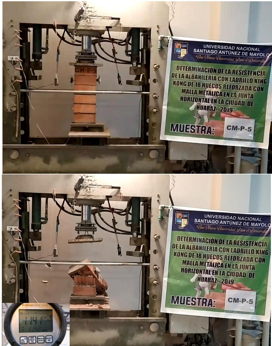
**Figura 6.10.** Arriba: Muestra CM-P-5 antes del ensayo; Abajo: Muestra CM-P-5 posterior al ensayo con su carga máxima.
