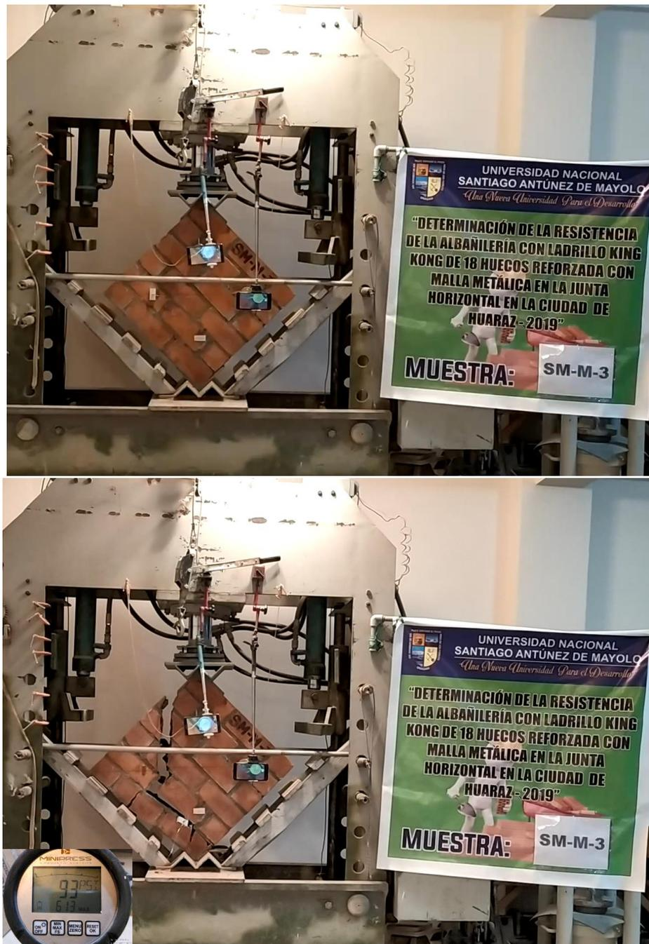
**Figura 6.14.** Arriba: Muestra SM-M-3 antes del ensayo; Abajo: Muestra SM-M-3 posterior al ensayo con su carga máxima.
