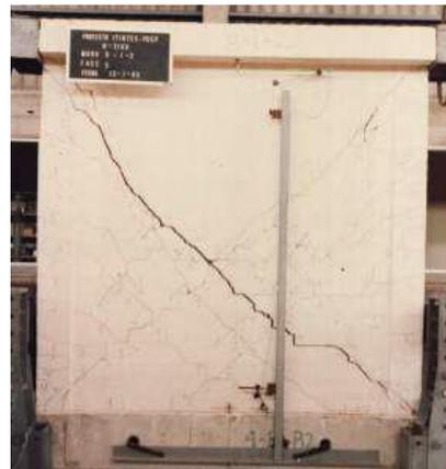
**Figuras 5.11.** Fallas por tracción diagonal.
