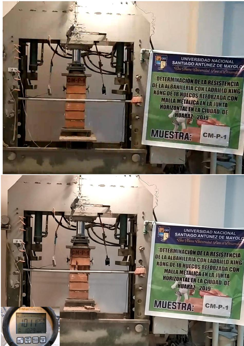
**Figura 6.6.** Arriba: Muestra CM-P-1 antes del ensayo; Abajo: Muestra CM-P-1 posterior al ensayo con su carga máxima.
