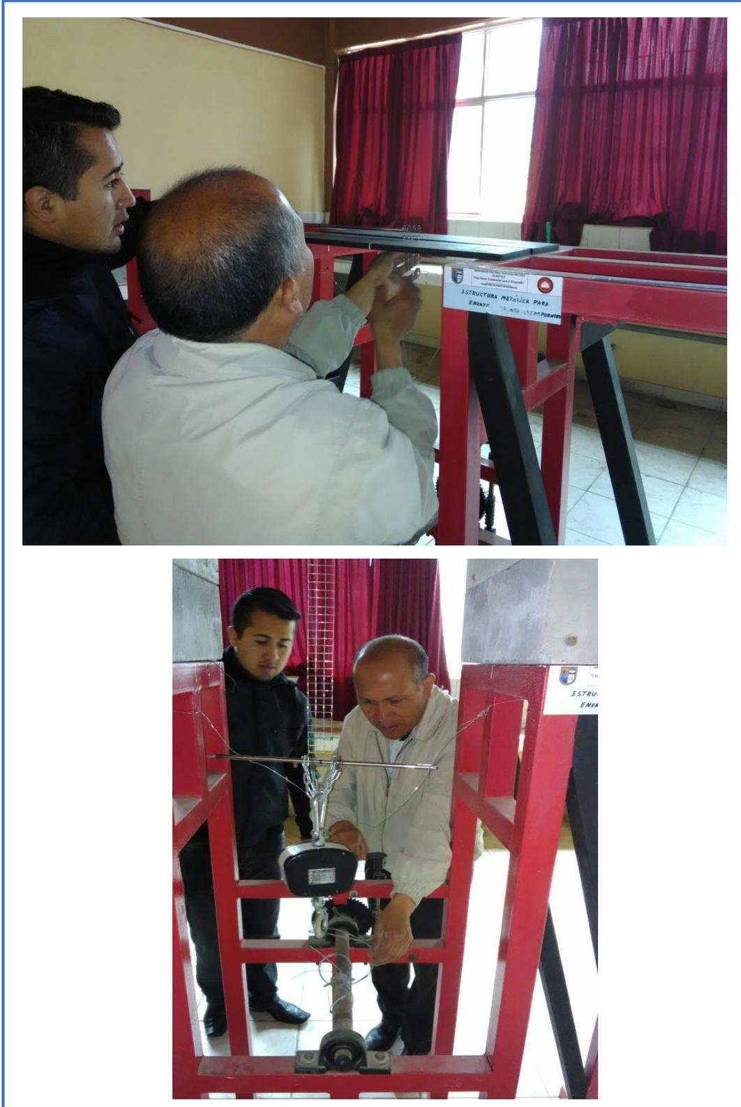
**Anexo 1.** Ensayos para calcular la resistencia a tracción de la malla metálica.
