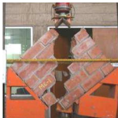
**Figura 5.12.** Falla escalonada en murete y en muros.
