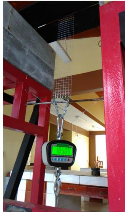
**Figura 3.4.** Ensayo a tracción de Malla electrosoldada – Configuración de 8 Hilos.
