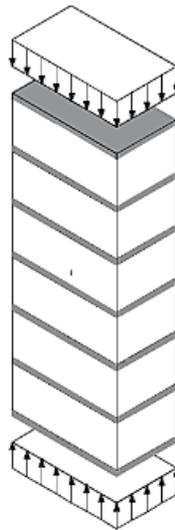
**Figura 4.9.** Compresión uniaxial de un prisma de albañilería.
