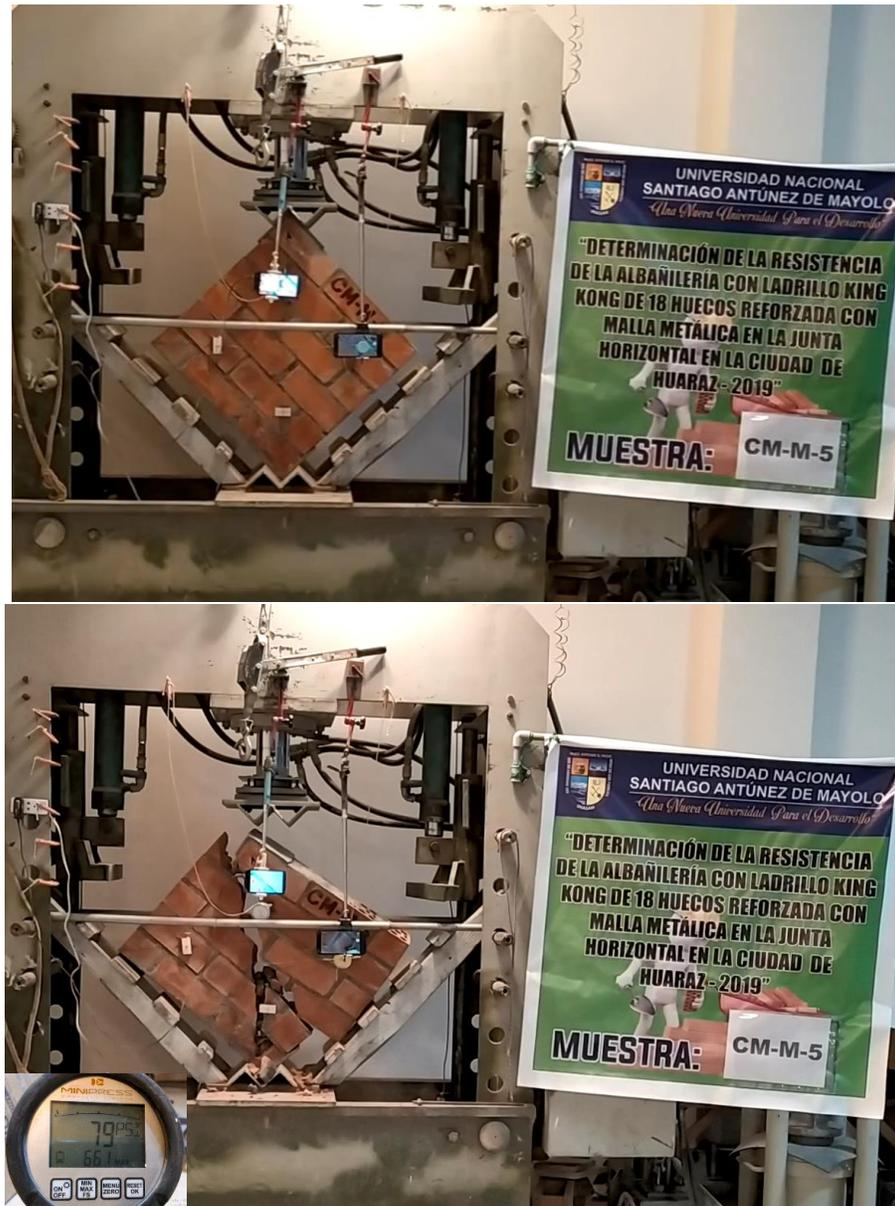
**Figura 6.22.** Arriba: Muestra CM-M-5 antes del ensayo; Abajo: Muestra CM-M-5 posterior al ensayo con su carga máxima.
