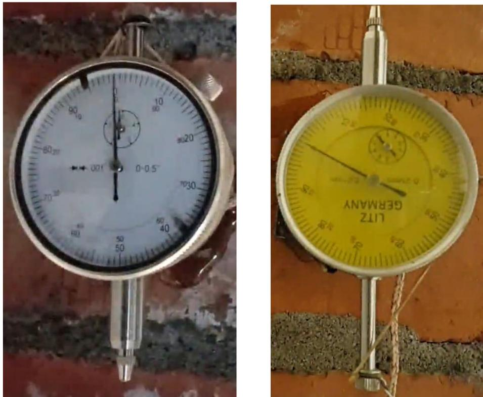
**Figura 3.9.** Dial de Deformación 1(Izquierda), Dial de Deformación 2 (Derecha).
