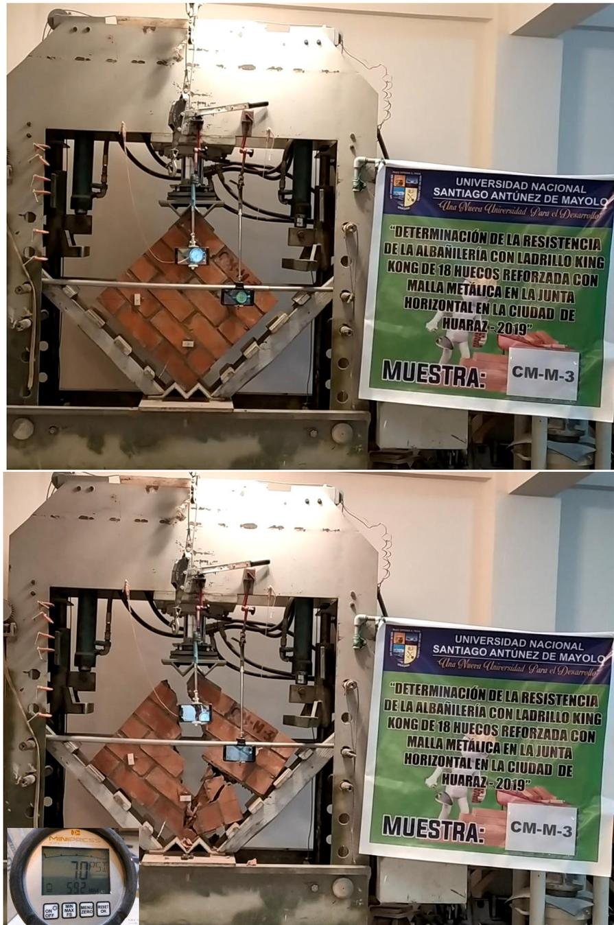
**Figura 6.20.** Arriba: Muestra CM-M-3 antes del ensayo; Abajo: Muestra CM-M-3 posterior al ensayo con su carga máxima.
