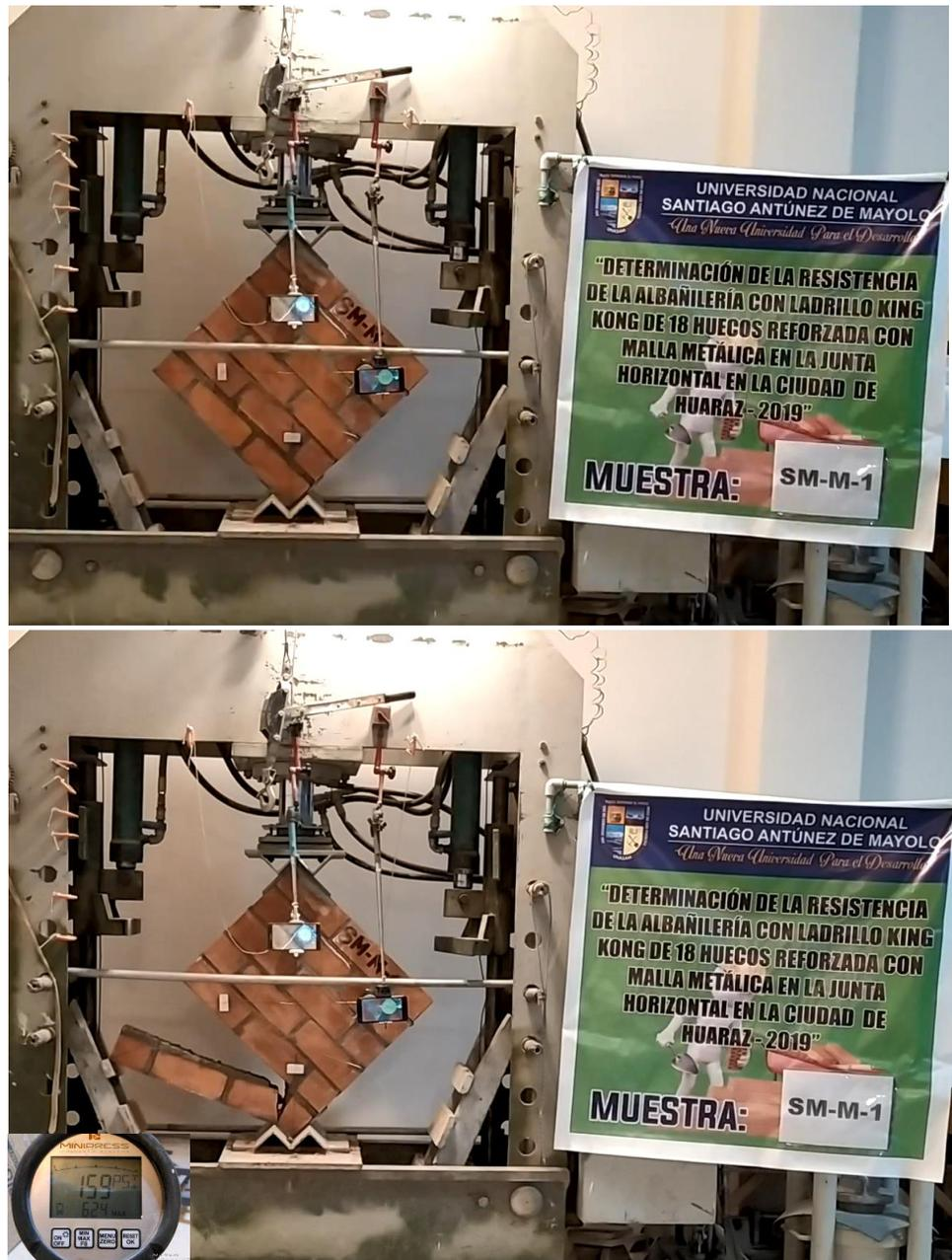
**Figura 6.12.** Arriba: Muestra SM-M-1 antes del ensayo; Abajo: Muestra SM-M-1 posterior al ensayo con su carga máxima.
