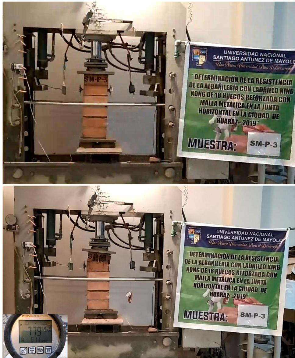
**Figura 6.2.** Arriba: Muestra SM-P-3 antes del ensayo; Abajo: Muestra SM-P-3 posterior al ensayo con su carga máxima.
