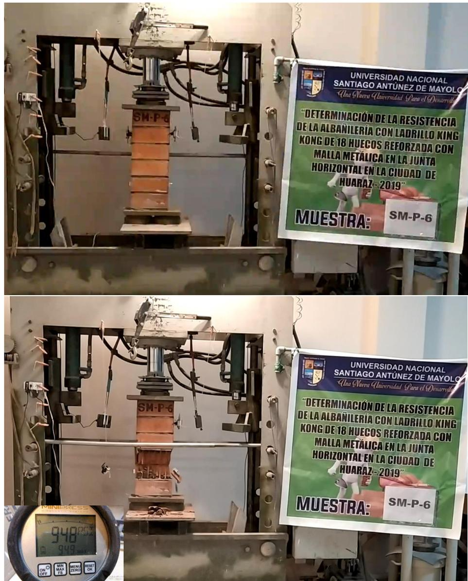
**Figura 6.5.** Arriba: Muestra SM-P-6 antes del ensayo; Abajo: Muestra SM-P-6 posterior al ensayo con su carga máxima.
