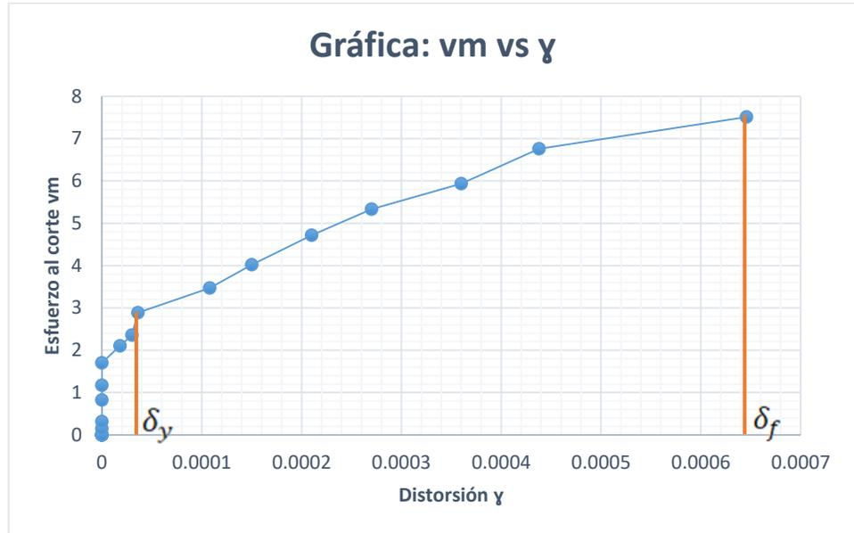
**Gráfico 5.** Curva esfuerzo al corte vs distorsión, hasta el punto de Rotura - Técnica 1
