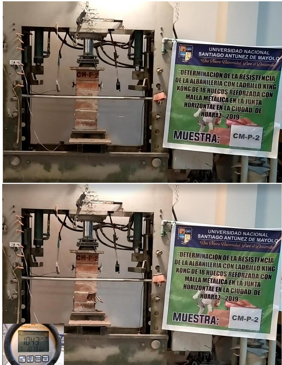
**Figura 6.7.** Arriba: Muestra CM-P-2 antes del ensayo; Abajo: Muestra CM-P-2 posterior al ensayo con su carga máxima.
