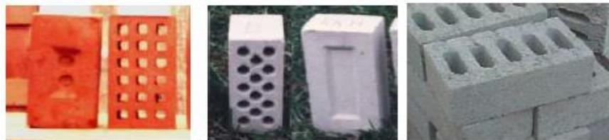
**Figura 2.0.** Ladrillos de arcilla (izquierda), sílice-cal (centro) y de concreto (derecha).
