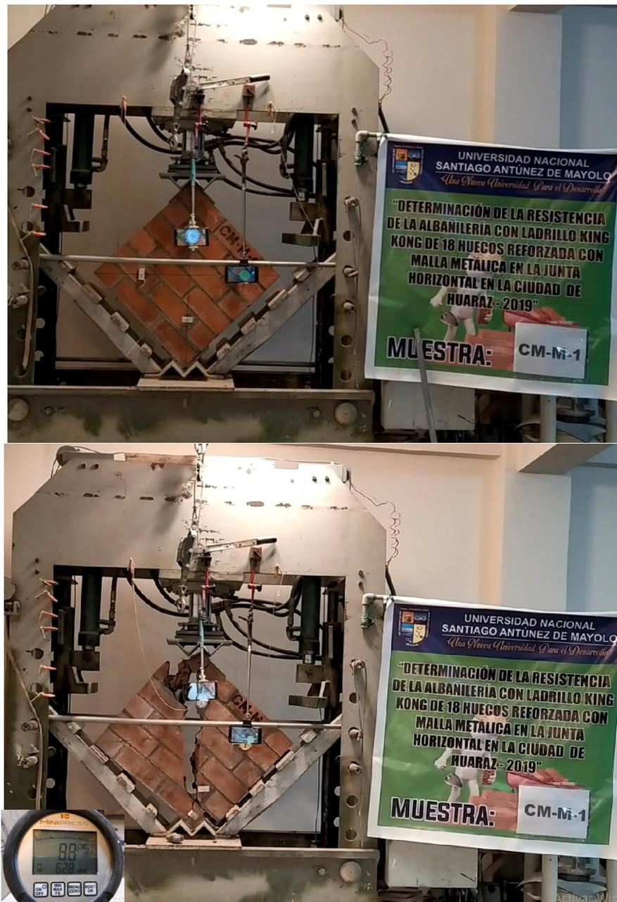
**Figura 6.18.** Arriba: Muestra CM-M-1 antes del ensayo; Abajo: Muestra CM-M-1 posterior al ensayo con su carga máxima.
