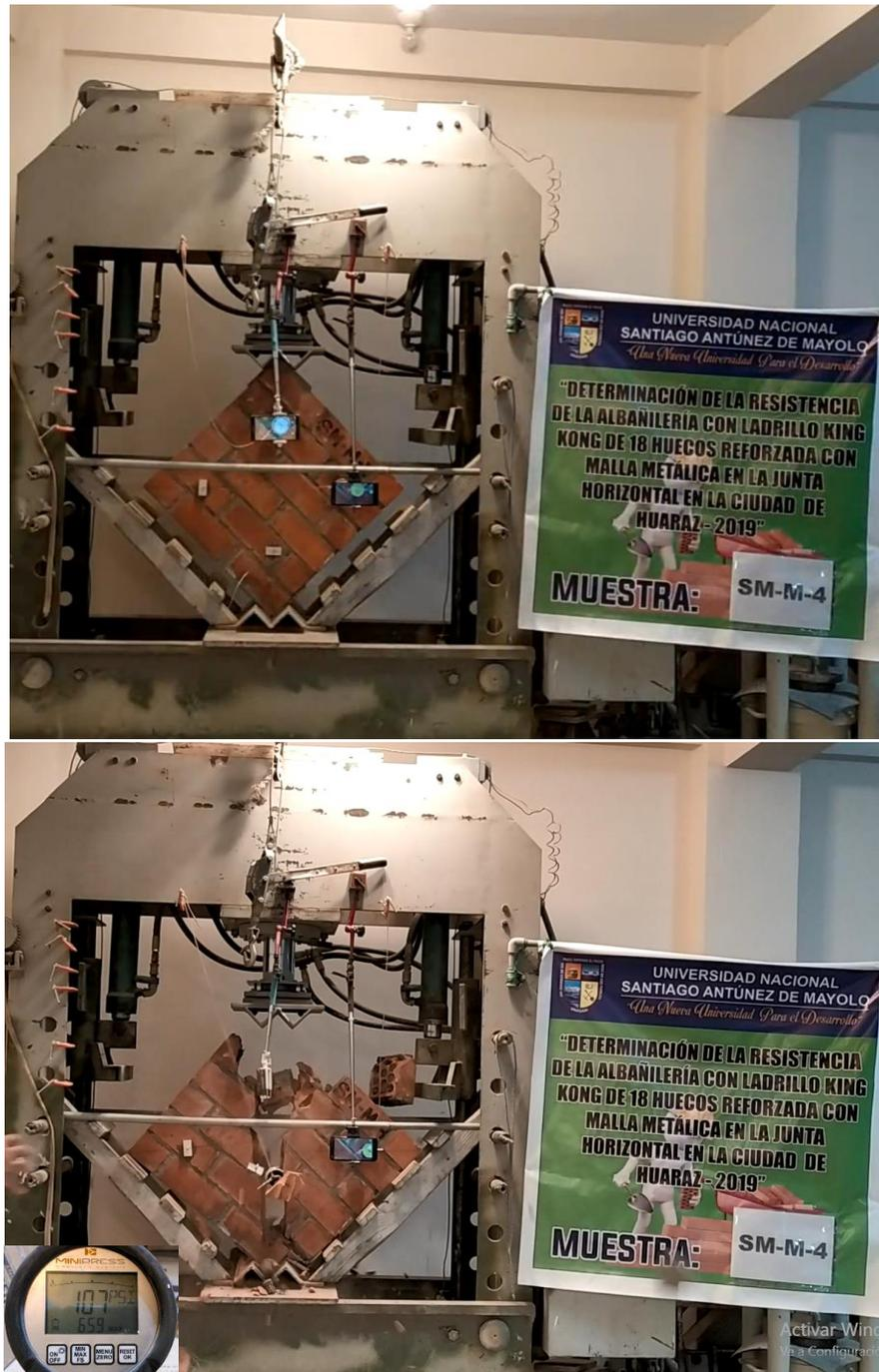
**Figura 6.15.** Arriba: Muestra SM-M-4 antes del ensayo; Abajo: Muestra SM-M-4 posterior al ensayo con su carga máxima.
