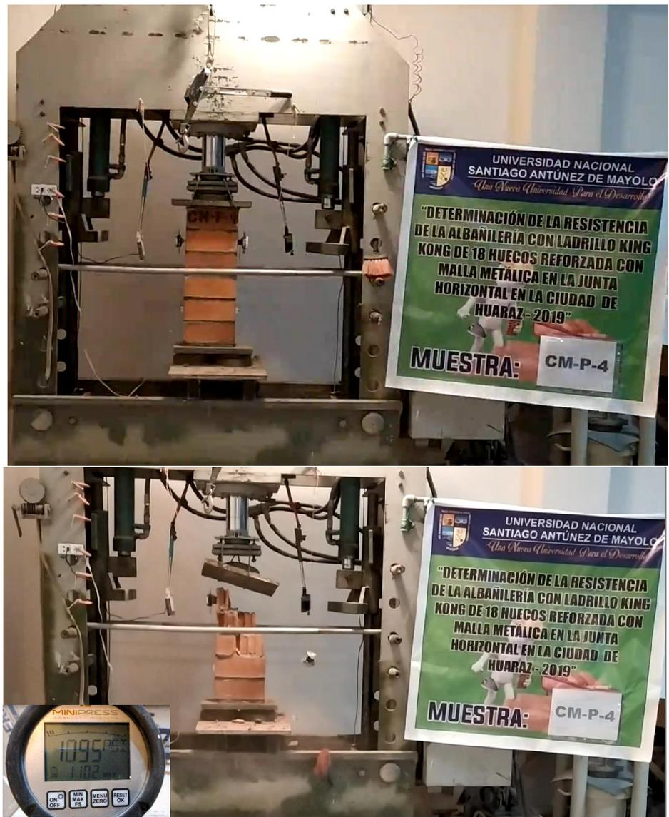
**Figura 6.9.** Arriba: Muestra CM-P-4 antes del ensayo; Abajo: Muestra CM-P-4 posterior al ensayo con su carga máxima.
