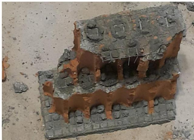
**Anexo 4.** Detalle de malla metálica posterior al ensayo.
