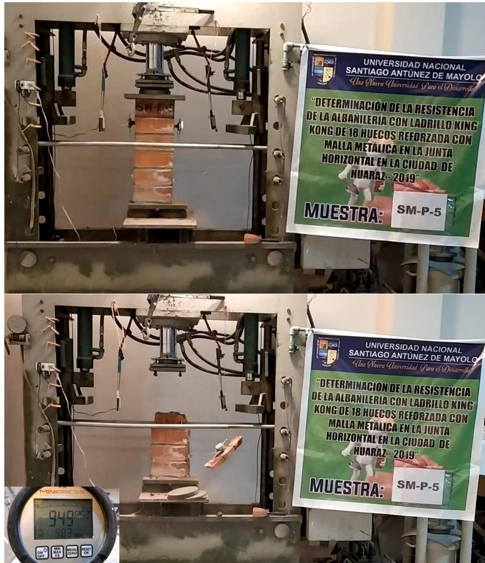
**Figura 6.4.** Arriba: Muestra SM-P-5 antes del ensayo; Abajo: Muestra SM-P-5 posterior al ensayo con su carga máxima.
