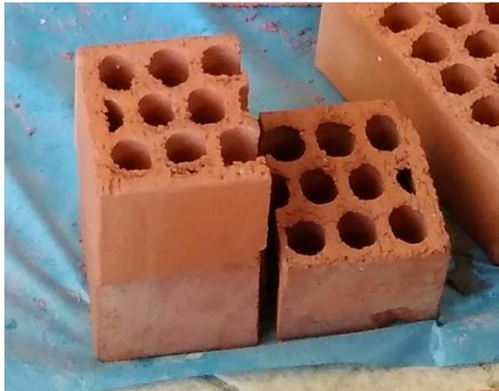
**Figura 5.3.** Corte de Unidad de Albañilería.
