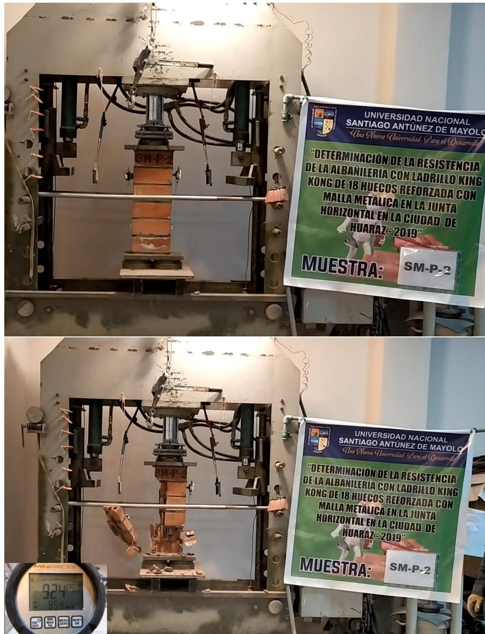
**Figura 6.1.** Arriba: Muestra SM-P-2 antes del ensayo; Abajo: Muestra SM-P-2 posterior al ensayo con su carga máxima.
