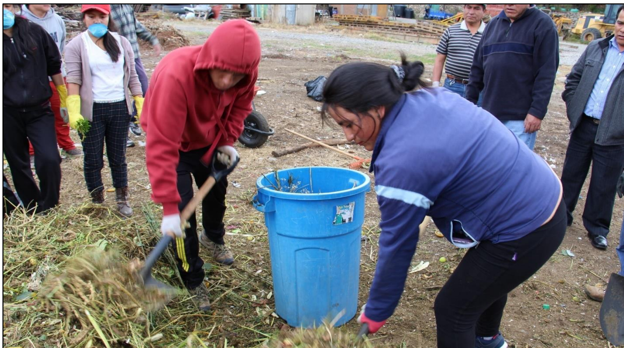
Fotografía 02: Se llenó los residuos en un cilindro para determinar la densidad de los residuos sólidos.
