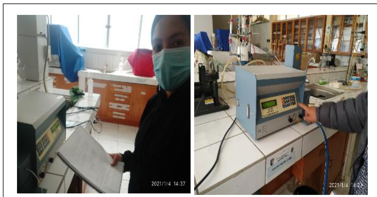
Fotografía 33 - 34: Preparación y calibración del equipo fotómetro llama para el análisis y la lectura del parámetro sodio en las muestras de agua.
