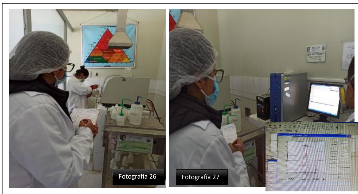
Fotografía 26 - 27: Calibración y determinación de los parámetros Mg, Ca y K, en el equipo de absorción atómica.
