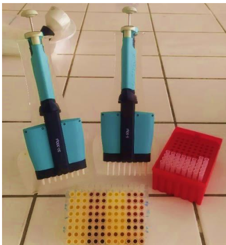
Micropipetas, tips y microplaca luego de la reacción de coloración con DNS posterior a la hidrólisis enzimática.
