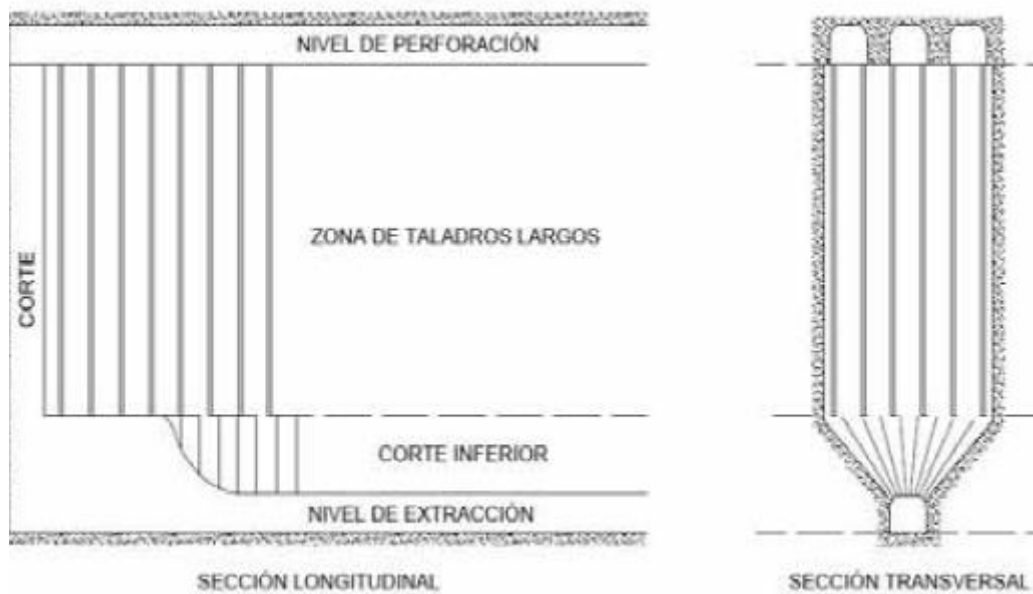
Figura N° 8. Esquema Long Hole Blasting.
