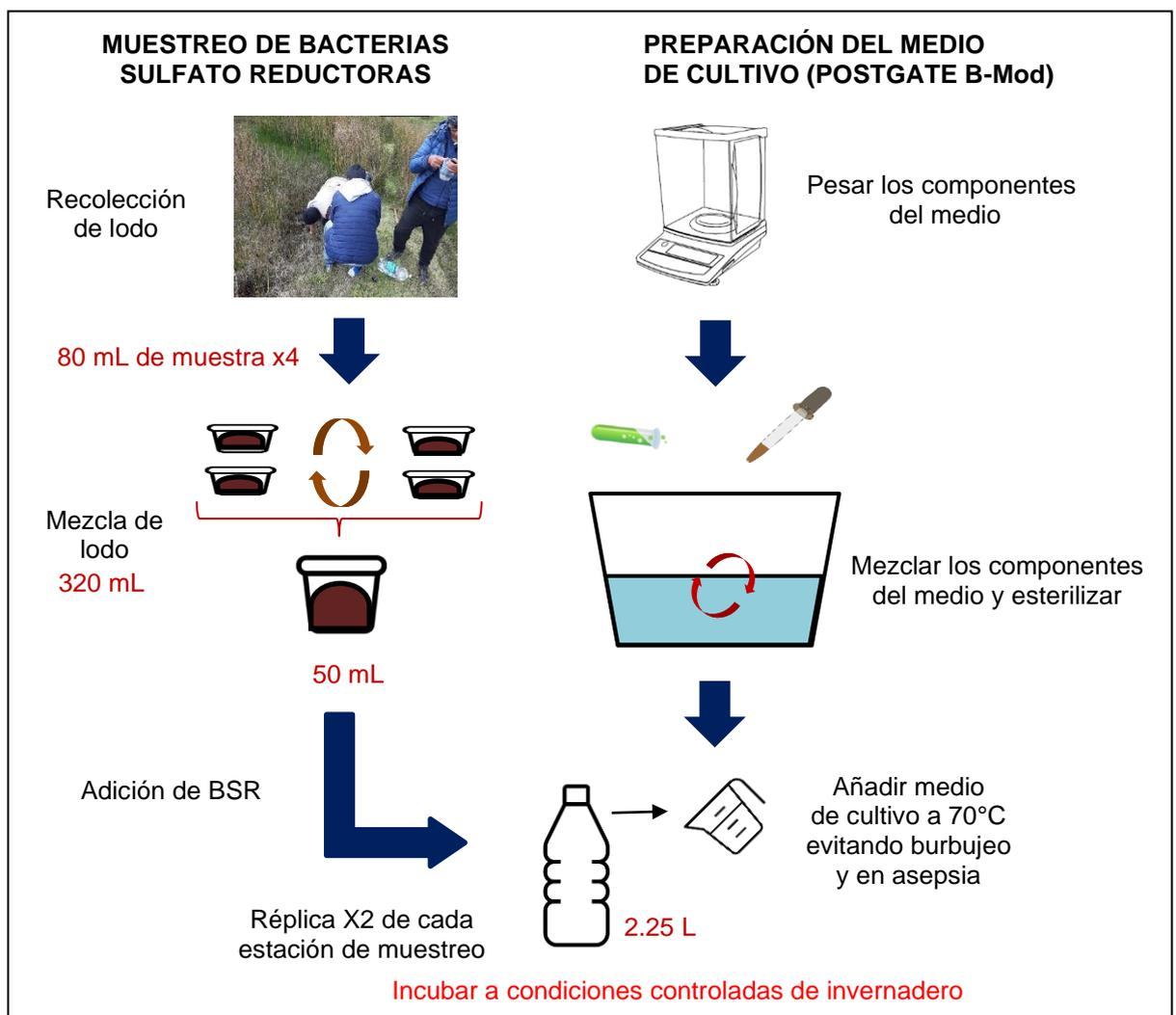
**Figura 17.** Esquema de aislamiento de las Bacterias Sulfato Reductoras (BSR) en medio de cultivo Postgate B Modificado.
