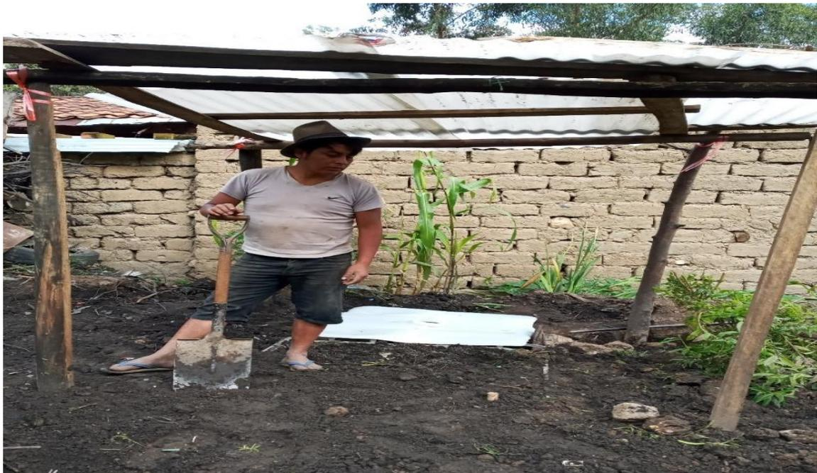
Figura 15. Techado de área de cultivo de papa en el lisímetro con eternit transparente
