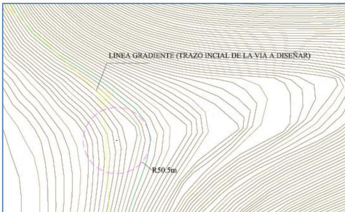
Nota. La figura muestra el *Radio mínimo aproximado a partir de las curvas de nivel*. Fuente: Propia (2020)
