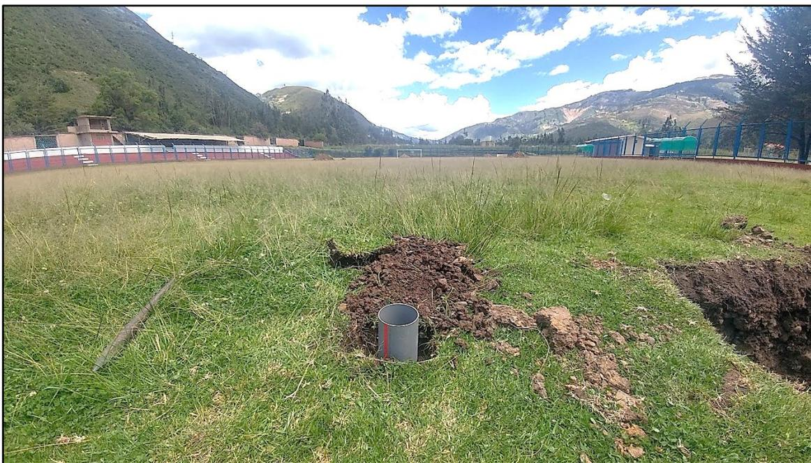
Foto n° 10: Toma de datos del nivel de descenso de agua en la Prueba de barreno Invertido.
