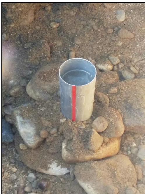
Foto n° 09: Prueba de barreno Invertido para cálculo de conductividad hidráulica del suelo.
