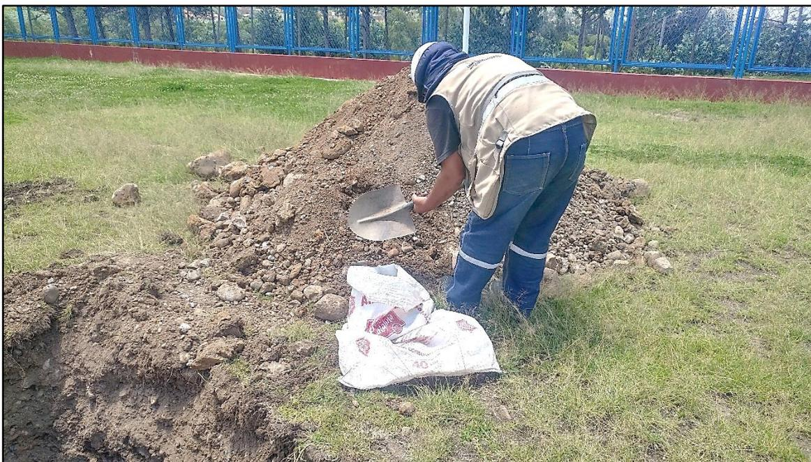
Foto n° 07: Prueba de barreno Invertido para cálculo de conductividad hidráulica del suelo
