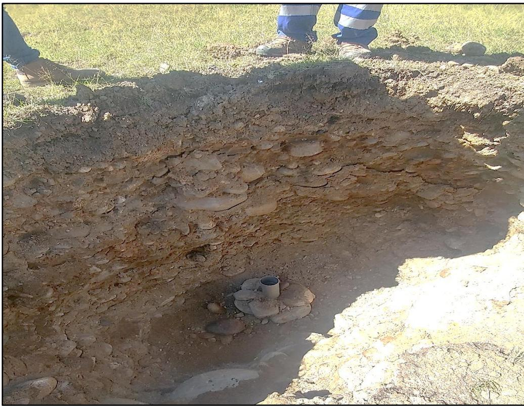
Foto n° 08: Prueba de barreno Invertido para cálculo de conductividad hidráulica del suelo.
