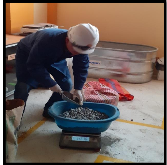
Figura 36. Imagen donde se aprecia el pesado de las dosificaciones.
