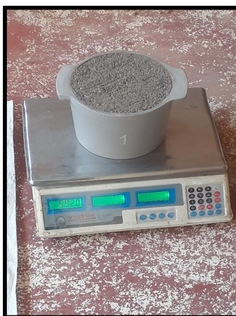
Figura 18. Determinación del PUSC, del agregado fino, en la balanza electrónica.
