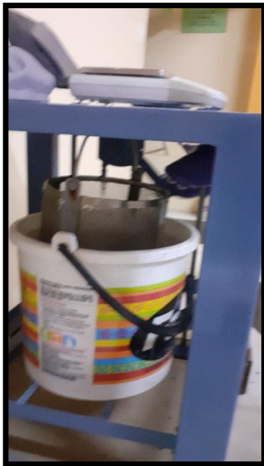
Figura 29. Ensayo para determinar porcentaje de absorción.
