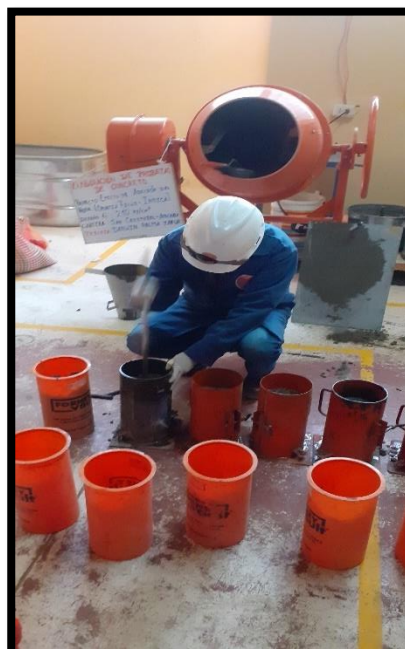
Figura 34. Imagen que muestra el chuceado (llenado de concreto en probetas).
