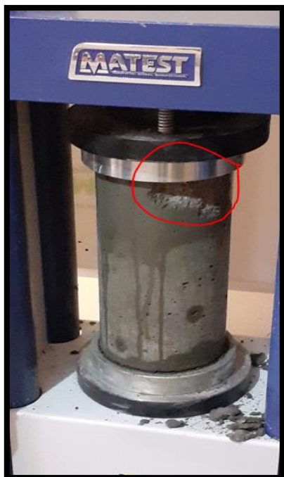
Figura 55. Se identifican el tipo de falla de la muestra, en este caso tipo 6.
