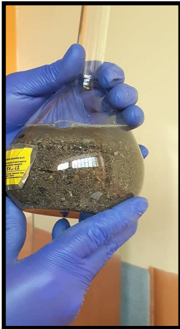
Figura 25. Quitando los vacíos de forma manual del picnómetro.
