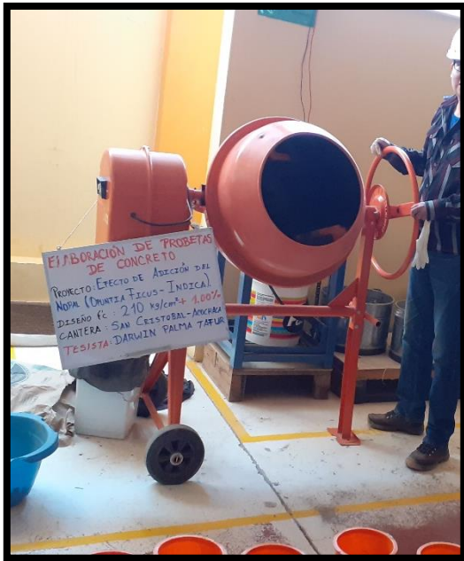
Figura 39. Diseño de mezcla, adicionando 1.00% de nopal.
