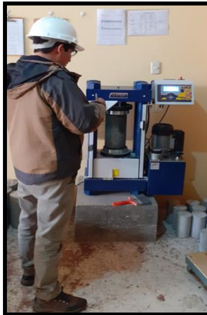
Figura 54. La imagen muestra la anotación del resultado de la resistencia a compresión.
