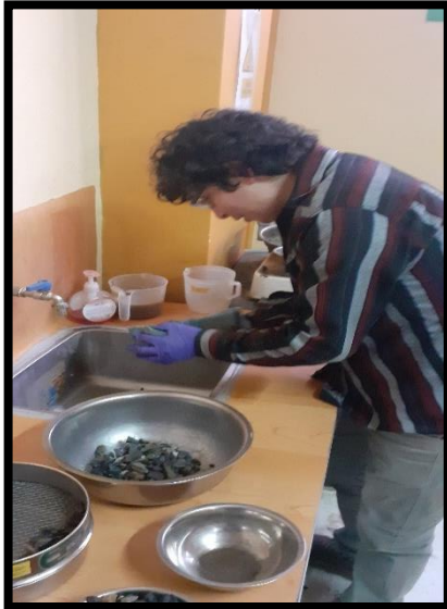
Figura 27. Secando el agregado grueso saturado, para determinar el peso específico.
