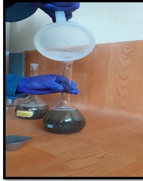
Figura 24. Llenando agua hasta 500ml del picnómetro.
