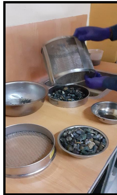
Figura 30. Retirado de la muestra saturada para ser pesado (parámetros que permitirán para determinar el % de absorción, agregado grueso).
