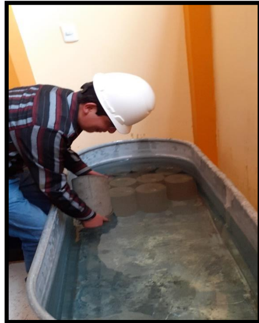
Figura 48. Colocación de las probetas, en el tanque para su curado.
