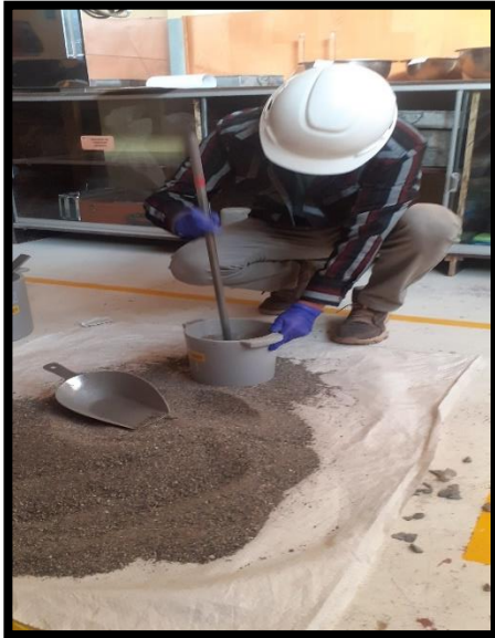
Figura 19. Varillando la primera capa de agregado fino, para determinar el PUCS.
