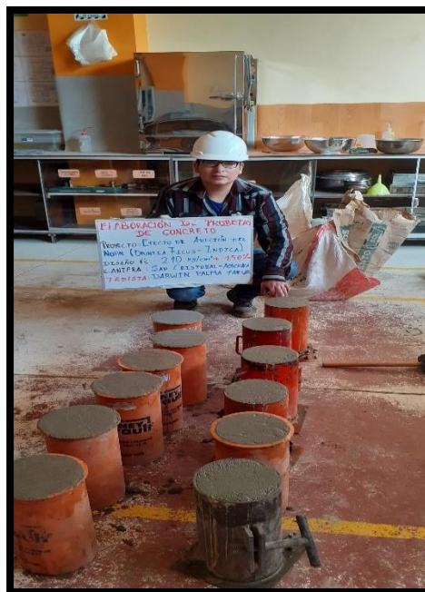
Figura 46. Ensayo finalizado, de probetas con la adición de 1.50% de nopal
