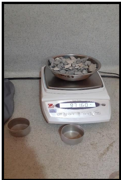
Figura 15. Pesando el agregado grueso para el contenido de humedad.
