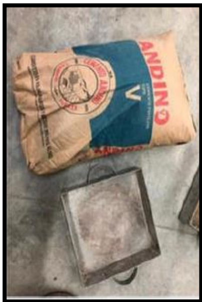
Figura 31. Imagen del tipo de cemento que se utilizó, en este caso cemento andino tipo V.
