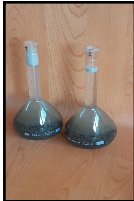
Figura 26. El material saturado se deja durante 24 hrs, para luego ser pesado y determinar el peso específico.
