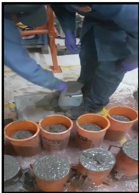
Figura 45. La imagen muestra la medida del slump, y su posterior llenado en las probetas.
