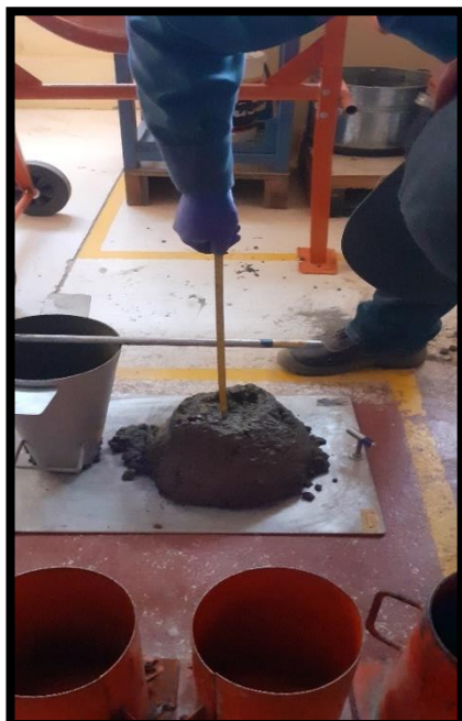
Figura 33. Medición del asentamiento (slump).
