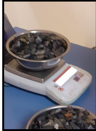
Figura 28. Pesando el agregado grueso, secado, para posteriormente ser llevado al horno.
