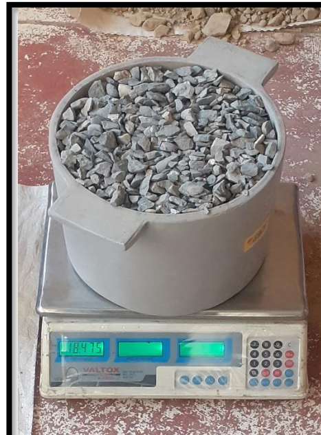
Figura 22. Determinación del PUCS, del agregado grueso, en la balanza
