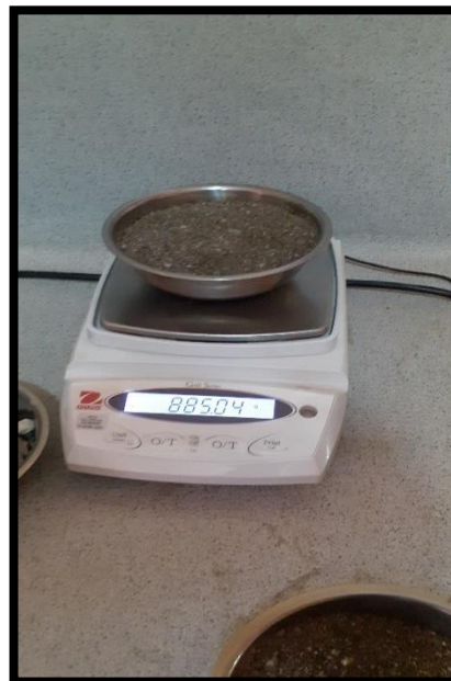
Figura 16. Pesando el agregado fino, para el contenido de humedad.
