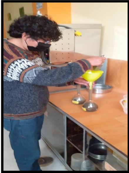
Figura 23. Ensayo para determinar Peso específico del agregado fino.
