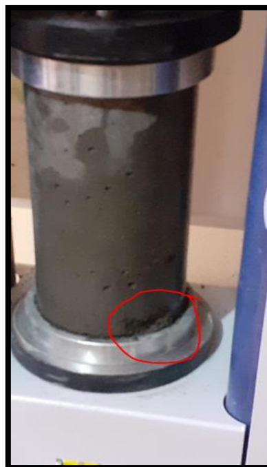
Figura 56. Tipo de falla identificada tipo 5.
