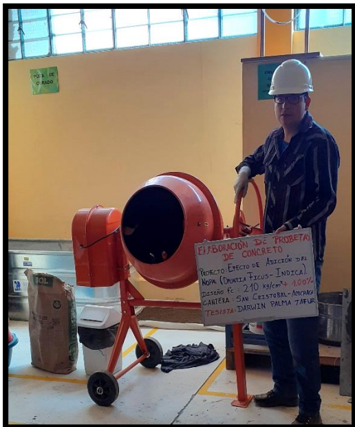
Figura 43. Diseño de mezcla, adicionando 1.50% de nopal.
