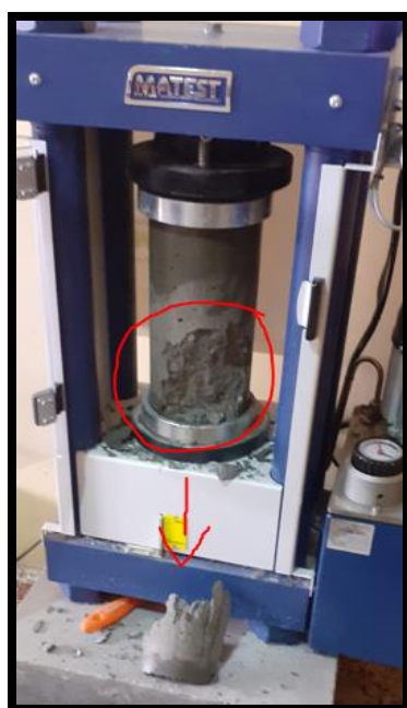
Figura 57. Tipo de falla identificada tipo 4.
