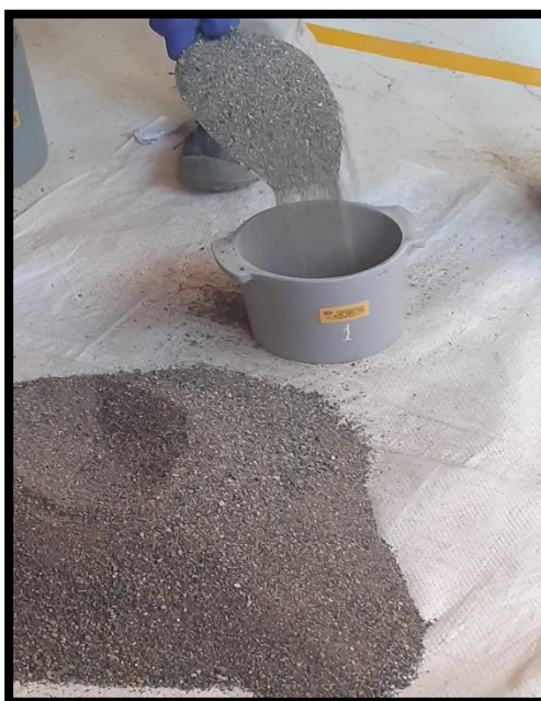
Figura 17. Procedimiento para el cálculo del PUSC, del agregado fino.
