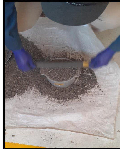
Figura 20. Enrasando el material excedente, para luego ser pesado en la balanza electrónica (PUCS).
