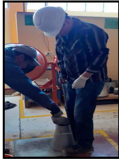
Figura 40. Llenando la muestra de concreto en el cono Abrams, para la determinación del slump.
