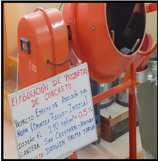
Figura 35. Diseño de mezcla, adicionando 0.5% de nopal.
