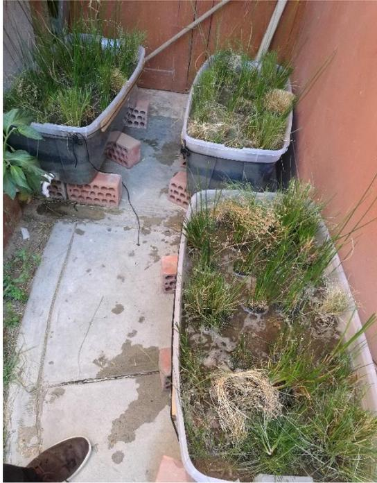
Los 3 sistemas piloto de fitorremediación anaeróbico instalados.
