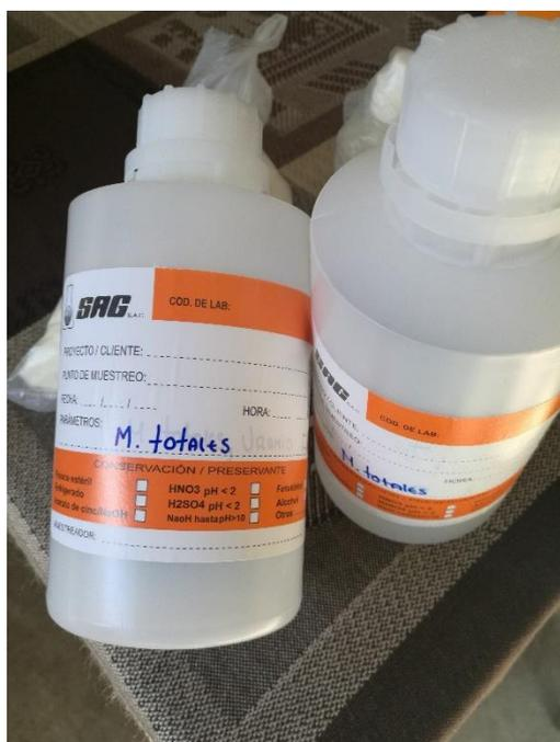
Muestras para el laboratorio para el análisis de metales totales en el efluente.
