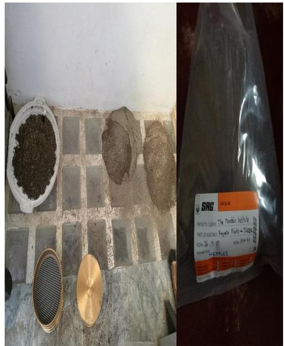
Muestras de Turba de los 3 sistemas piloto de fitorremediación anaeróbico para ser enviadas al laboratorio para el análisis de metales totales en suelo.
