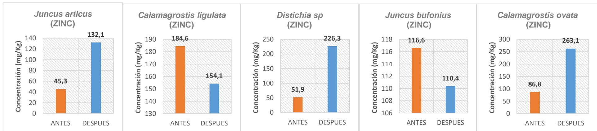
**Figura 23.** Comparación de la acumulación de zinc entre las especies vegetales antes y después de ser introducidas al sistema piloto de fitorremediación anaeróbica.
