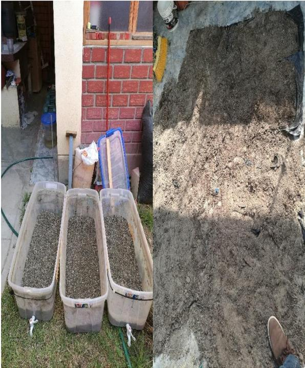
Recolección de sedimentos de los 3 sistemas pilotos de fitorremediación anaeróbico instalados.
