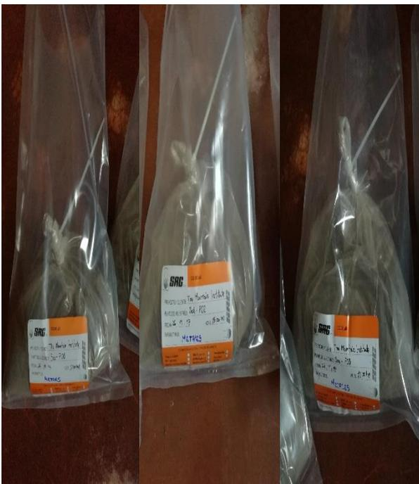
Muestras de sedimento de los 3 sistemas piloto de fitorremediación anaeróbico para ser enviadas al laboratorio para el análisis de metales totales en suelo.
