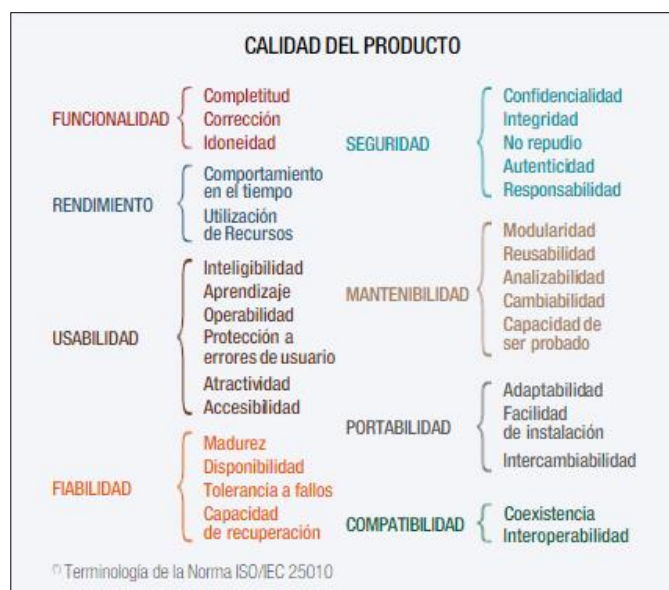
Modelo de calidad del producto software según la ISO/IEC 25010
