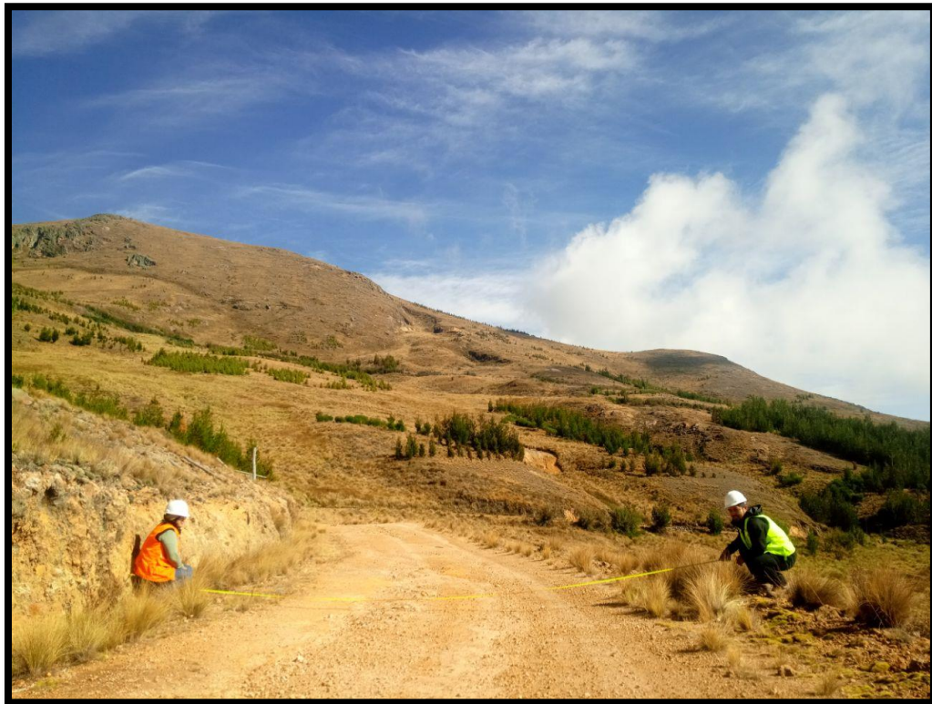
Fotografía 05: Medición de ancho de plataforma.
