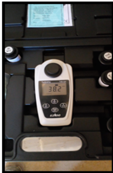
FOTOGRAFÍA 26: Resultado de la turbiedad (salida del sistema)
