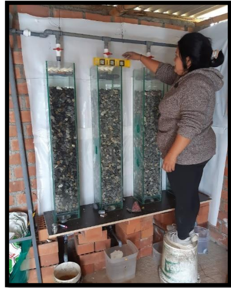
FOTOGRAFÍA 12: Nivelación del filtro
