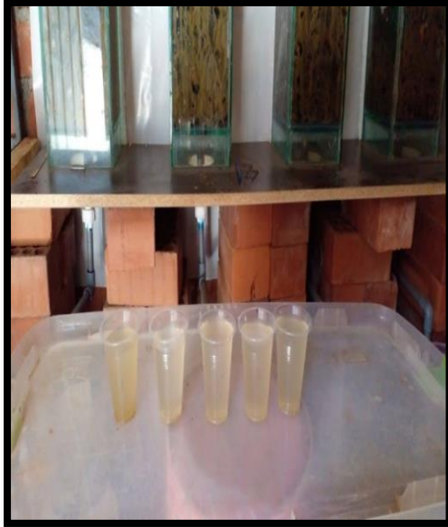
FOTOGRAFÍA 18: Muestras de entrada y salidas del filtro percolador
