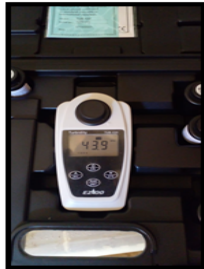
FOTOGRAFÍA 27: Resultado de la turbiedad (salida del sistema)
