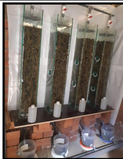
FOTOGRAFÍA 17: Muestras de entrada y salidas del filtro percolador
