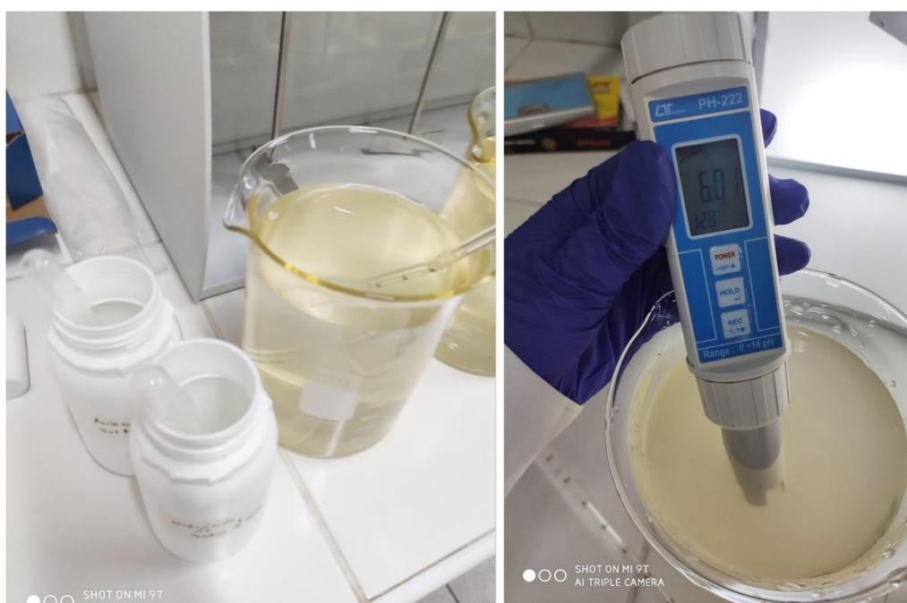
**Imagen 7:** Extracción del sulfato de aluminio para su dilución (izquierda) y proceso de disolución con agua destilada (derecha)
