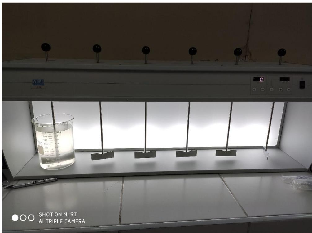
**Imagen 11:** Ensayo de floculación con un tipo de coagulante, un pH, una dosis y una gradiente establecida para tiempos de floculación T de 5, 10, 15, 20, 30 y 40 min y un tiempo de sedimentación de 20 min.
