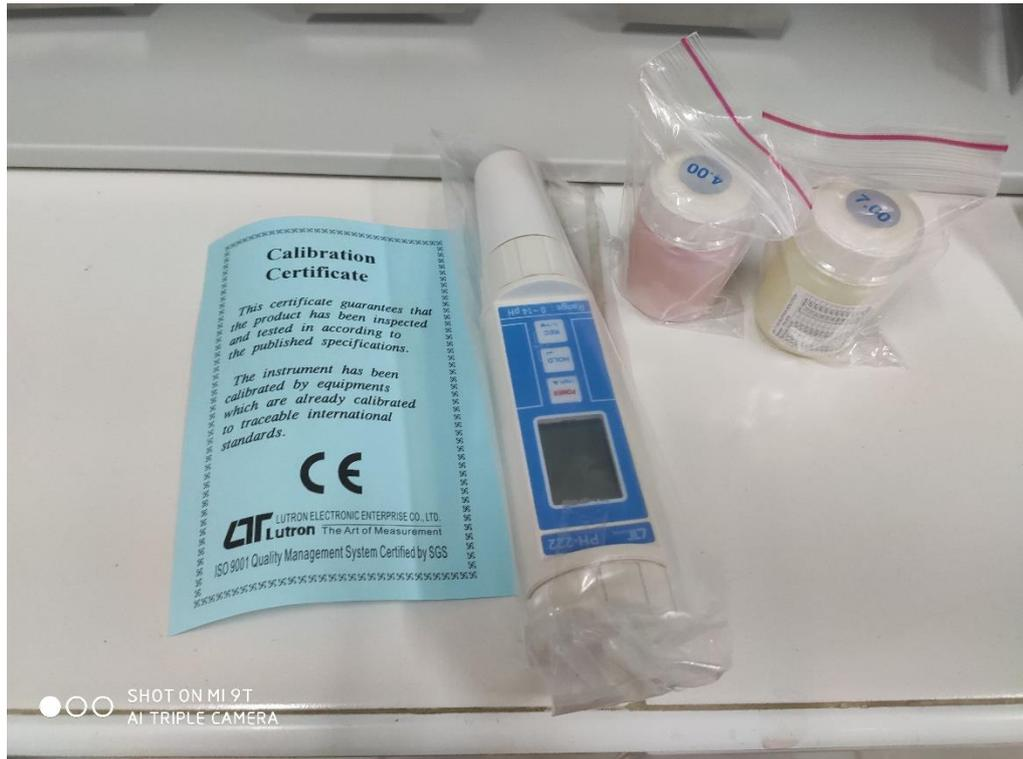
Imagen 4: Calibración de turbidímetro con los estándares de calibración.
