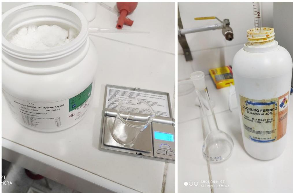
**Imagen 9:** Soluciones stock de Sulfato de Aluminio (izquierda) y Cloruro Férrico (derecha) al 1% de concentración.
