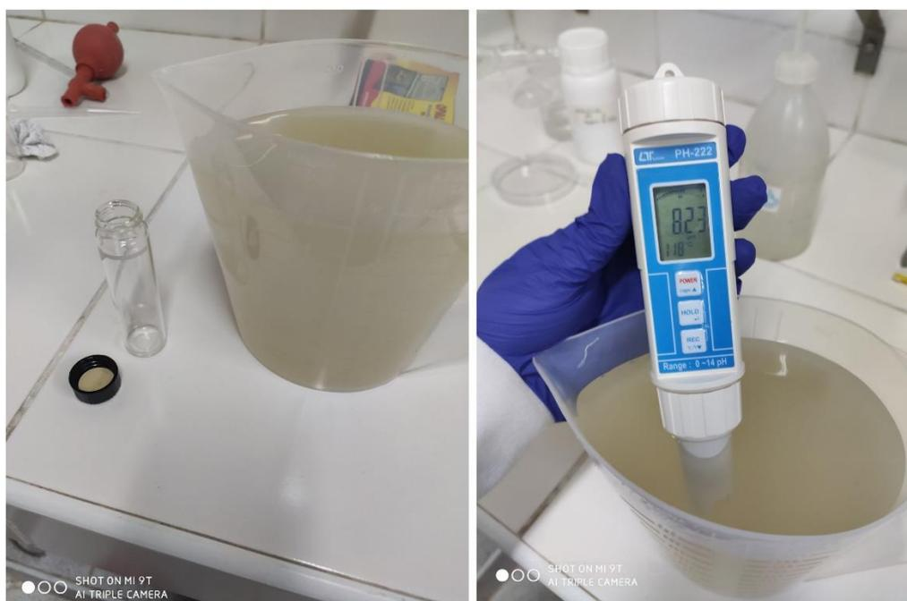
**Imagen 6:** Corrección de pH del agua con NaOH y/o H<sub>2</sub>SO<sub>4</sub> 0.1N en 1L de muestra a un valor deseado.
