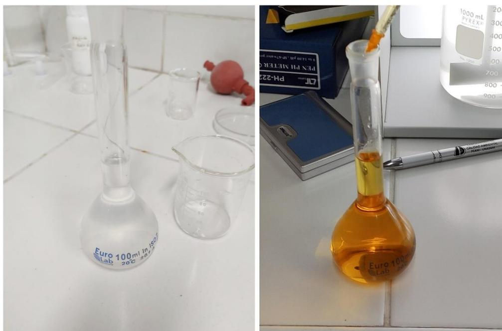
**Imagen 10:** Realización de la mezcla rápida para un tipo de coagulante (Cloruro Férrico en este caso), un pH y una dosis establecida para un tiempo de floculación  $T=0$  y tiempo de sedimentación de 20 min.
