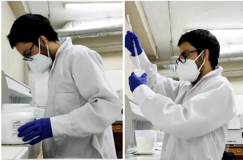
**Imagen 8:** Preparación de solución de Sulfato de Aluminio y Cloruro Férrico al 1% a partir de concentraciones de 99.5% y 40% de Sulfato de Aluminio y Cloruro férrico comerciales respectivamente.
