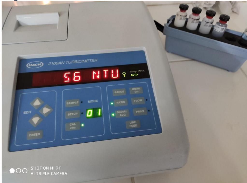
**Imagen 5:** Extracción de 30 ml de muestra para medición de turbiedad y medición de pH y temperatura del agua cruda.
