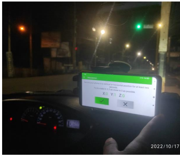
Foto 13: Calibración de ubicación X=0, Y=0 y Z=0, en el aplicativo para iniciar el recorrido.
