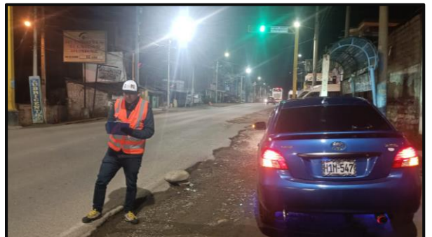
Foto 04: instrumentos para la realización de medición del IRI con telefono inteligente, sujetador, vehículo y tabla de apuntes
