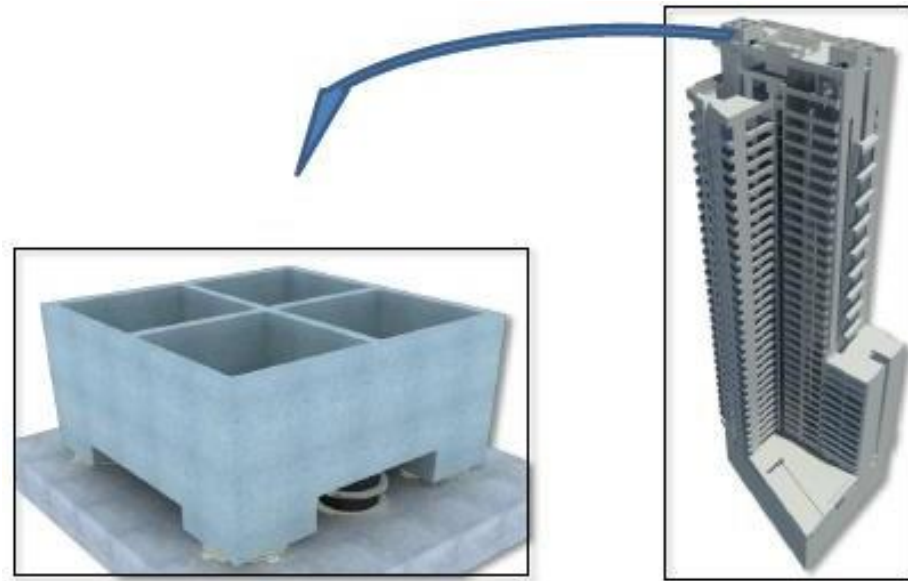
Ilustración 7: Amortiguadores de Masa Sincronizada en el Edificio Geocentro Agustinas (Chile)
