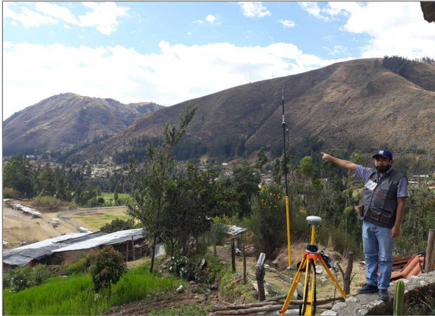
Figura 85: Vista panorámica con GPS diferencial.
