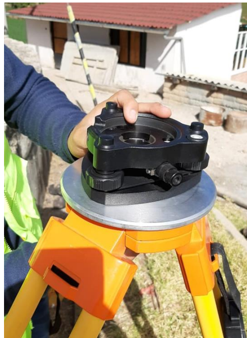
Figura 74: Colocación del soporte del trípode y base del gps diferencial.
