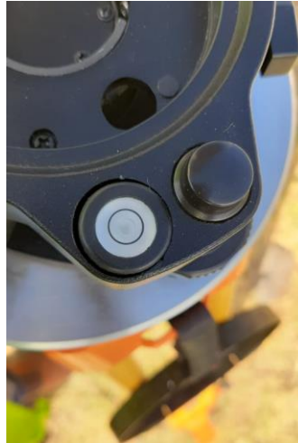
Figura 76: Calado de ojo de pollo de trípode de gps diferencial.
