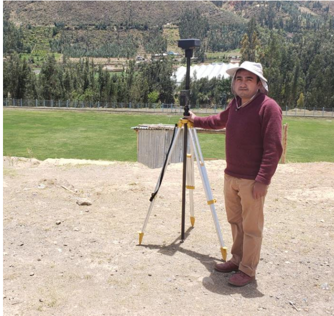
Figura 29: Trípode y D-RTK 2 nivelado.
