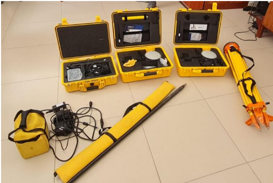
Figura 72: Materiales y equipos usados para la recolección de datos con gps diferencial.
