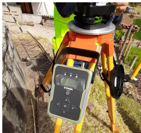
Figura 78: Colocación de la radio antena del gps diferencial.
