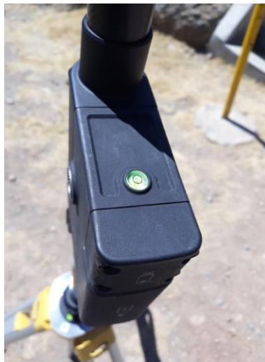
Figura 28: Nivelación del nivel esférico del D-RTK 2.
