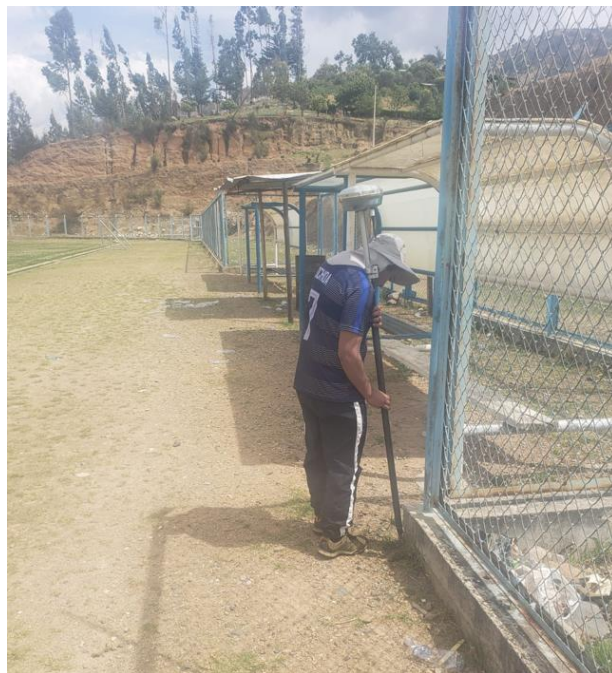
Figura 86: Recolección de datos con GPS diferencial.
