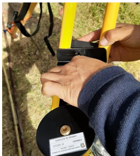
Figura 79: Colocación de la base de soporte de la antena del gps diferencial.
