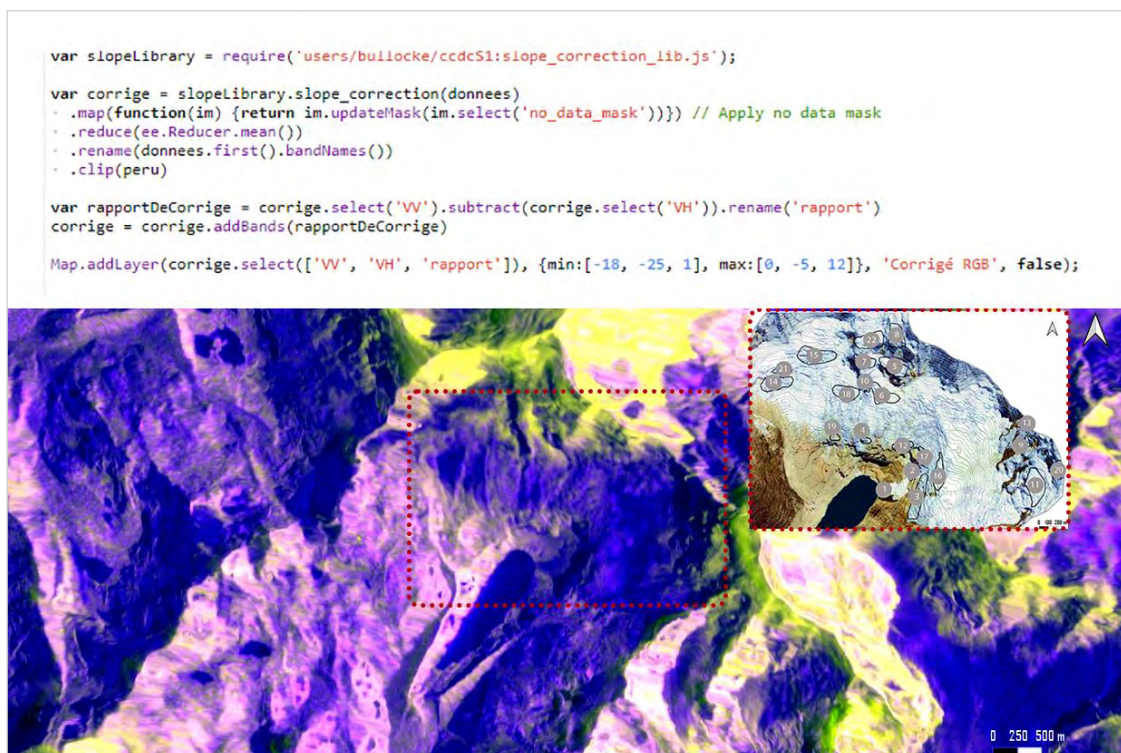
Figura 51. Algoritmo de corrección de pendiente radiométrica e imagen SAR en RGB.
