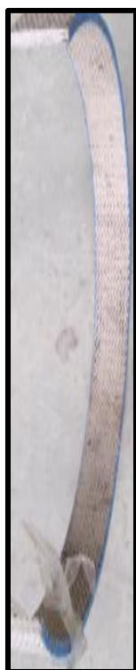
Figura 23. Evaluación de desgaste de la faja de freno como la faja de embrague
