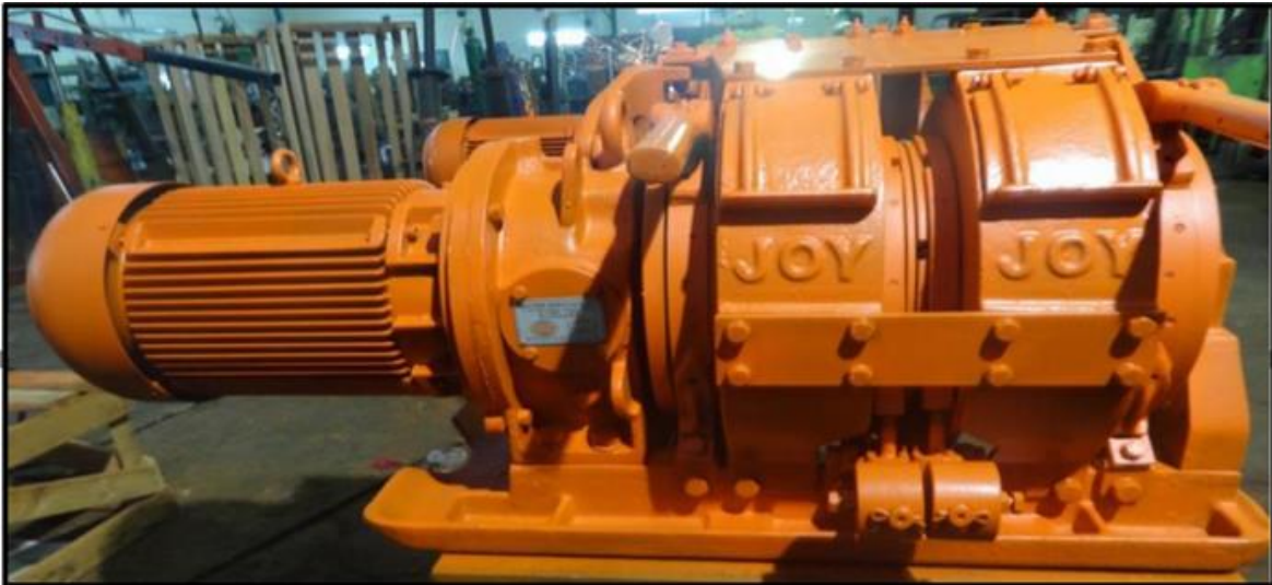
Figura 6. Winche eléctrico de rastrillaje.
