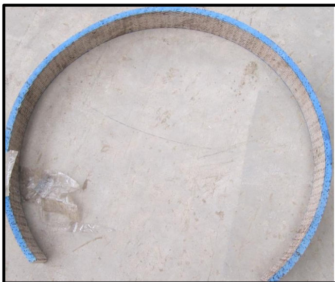
Figura 22. Evaluación de desgaste de la faja de freno como la faja de embrague
