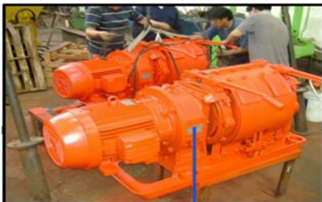
Figura 8. Winche eléctrico de rastrillaje.
