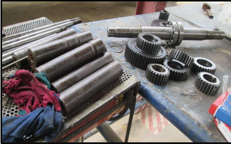
Figura 38. Limpieza y engrase de elementos del winche.
