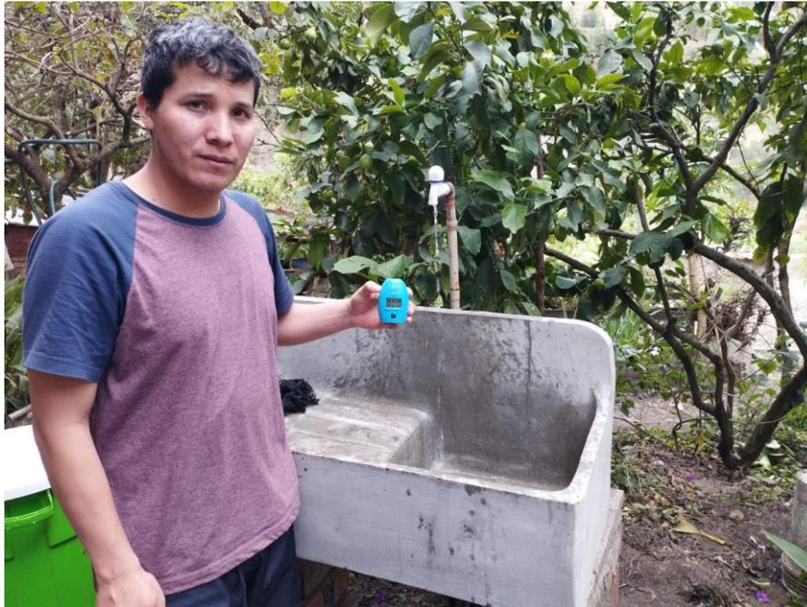
**Fotografía 7.** Medición de cloro residual libre en las viviendas de la microcuenca Caras, para determinar la calidad del agua potable.
