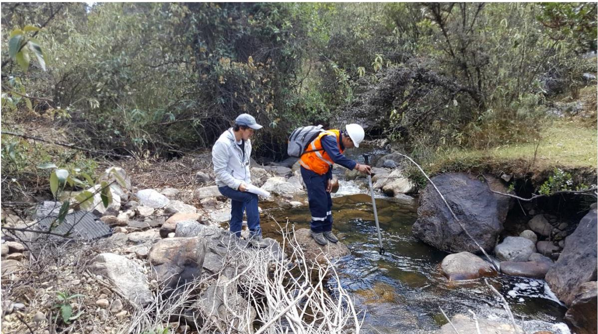
**Fotografía 12.** Medición de caudal de los principales ríos de la microcuenca Carash, usando el correntómetro.
