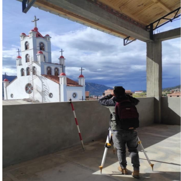
Fotografía N°02 Levantamiento Topográfico al lateral izquierdo de la iglesia
