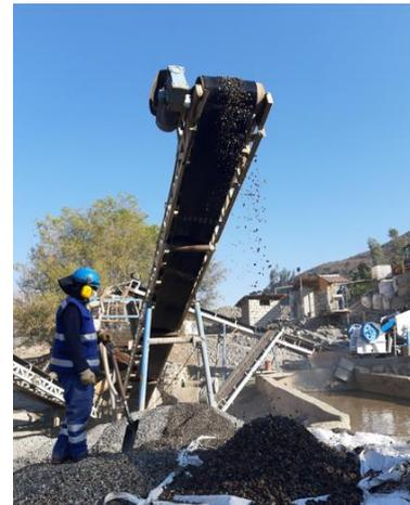
**FOTO N°06:** Obtención del agregado grueso
