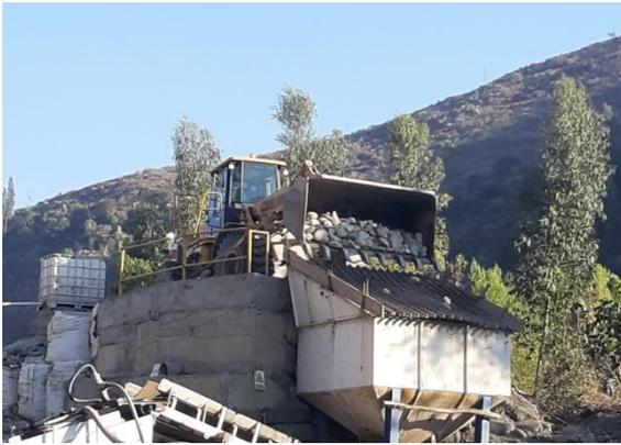
**FOTO N°05:** Proceso de chancado del agregado
