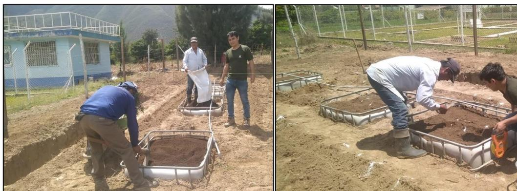
*Nota.* En la primera imagen, se muestra la incorporación de materia orgánica en los lisímetros, lo cual es fundamental para mejorar la estructura y fertilidad del suelo.
