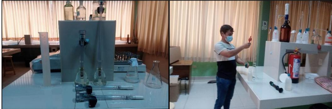
En el laboratorio de suelos de la UNHEVAL, se procedió a calibrar los tensiómetros usando agua destilada para humedecer la capsula porosa de porcelana y preparar la solución anti algas mediante el uso de una pipeta, matraz y piseta.
