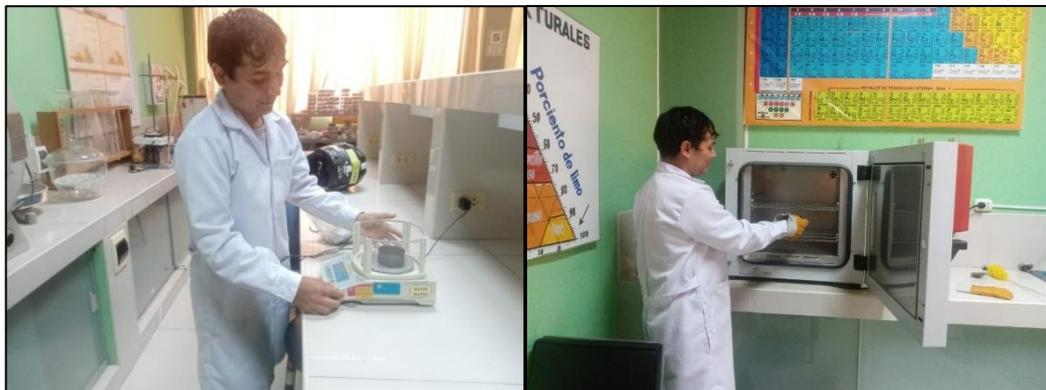
Posteriormente, se usó una estufa, balanza granataria, desecador y guantes. Donde se procedió a obtener el peso del suelo húmedo (gr) y el peso del suelo seco (gr).
