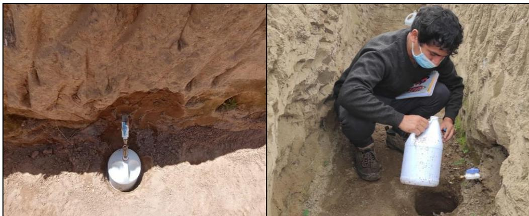
*Nota.* En la primera imagen se muestra el sistema de drenaje de uno de los lisímetros, el cual incluye una llave de paso con su respectivo grifo, así como un colector de 5 litros. En la segunda imagen, se está llevando a cabo la evaluación de los contenedores para verificar si hay presencia de agua drenada.
