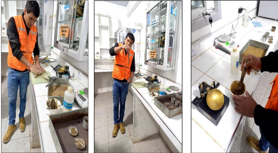
Fotografía 18-20. Prueba de las propiedades físicas del suelo: cinta de barro, límite líquido, límite de plasticidad.
