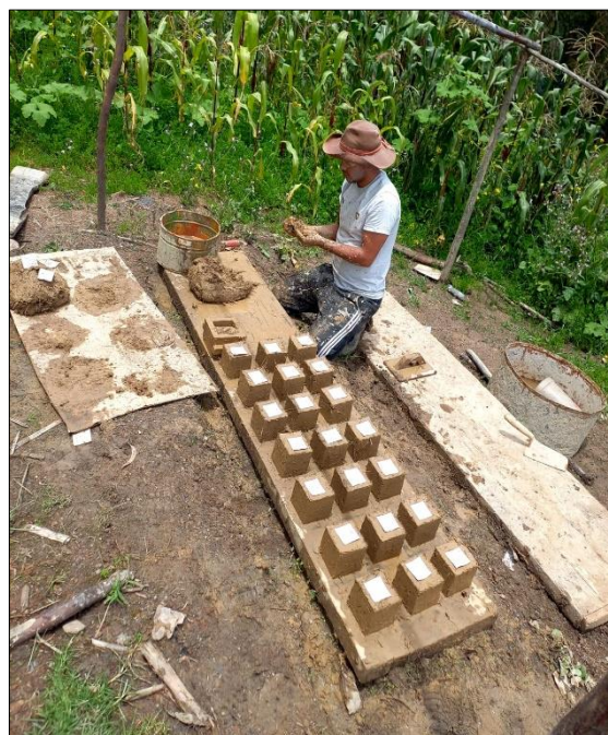
Fotografía 15 – 17. Formación de adobes y su preparación para el secado.
