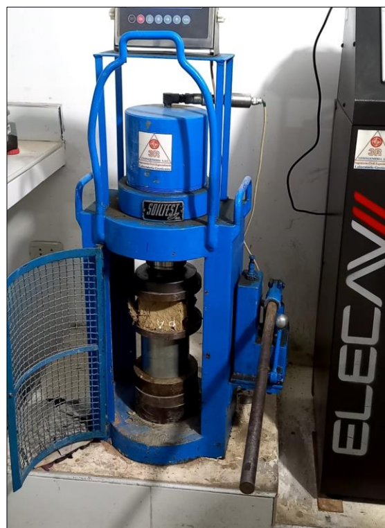
Fotografía 26-27. Preparación de los adobes en la máquina de compresión.
