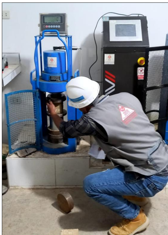
Fotografía 26-27. Preparación de los adobes en la máquina de compresión.
