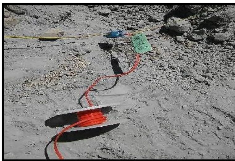
Figura N° 23. Conexión del conector al cable de conexión.
