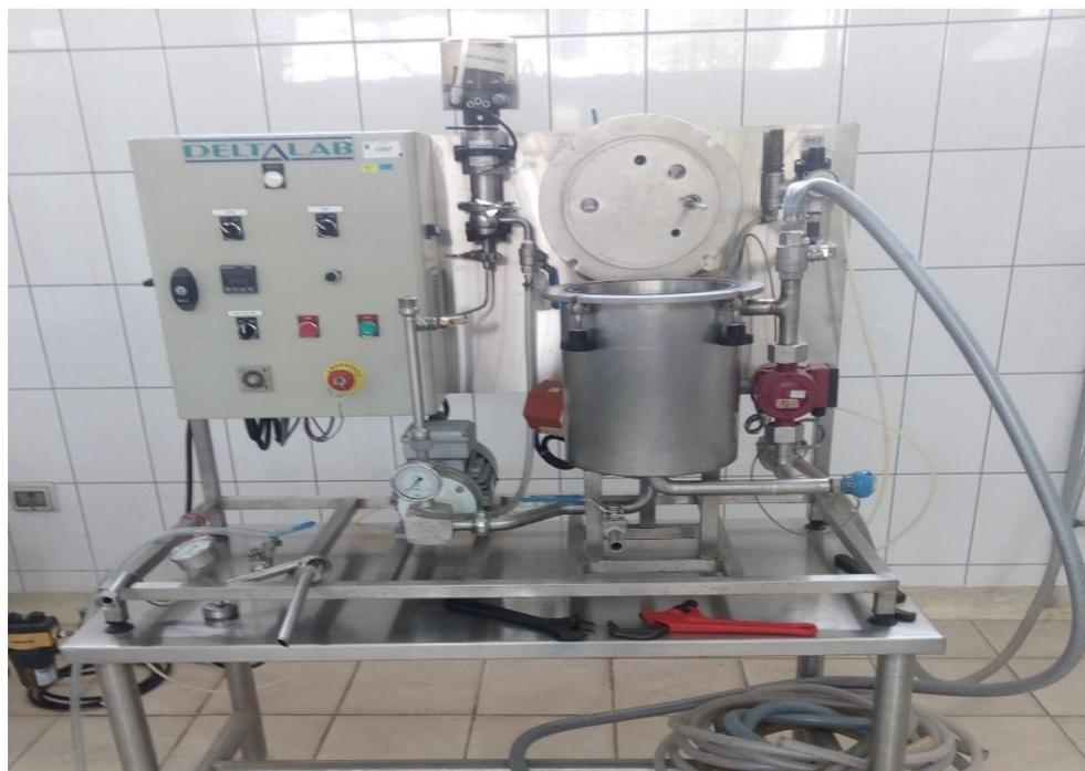
**Fotografía 13. Equipo de microfiltración por membranas**
