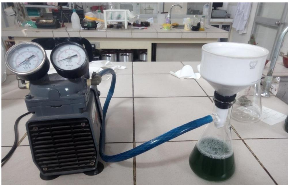
**Fotografía 10. Filtración rápida por bombas de la mezcla.**
