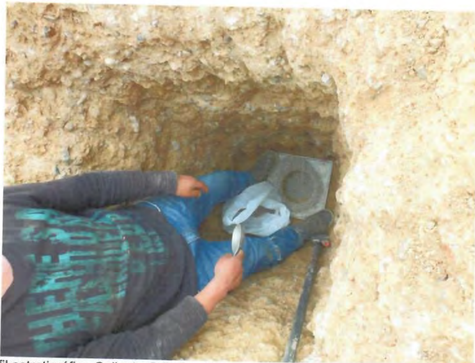
Perfil estratigráfico Calicata C-5. Se observa la grava arcillosa con arena y ensayo de densidad de campo.
