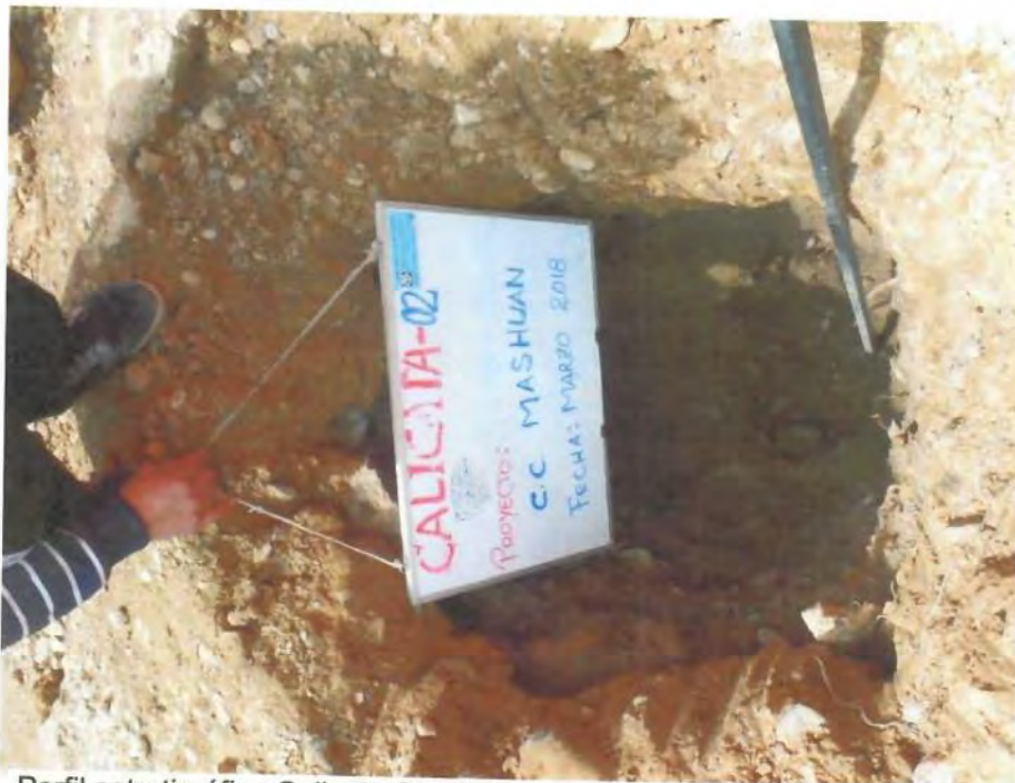
Perfil estratigráfico Calicata C-2. Se observa la grava arcillosa con arena.
