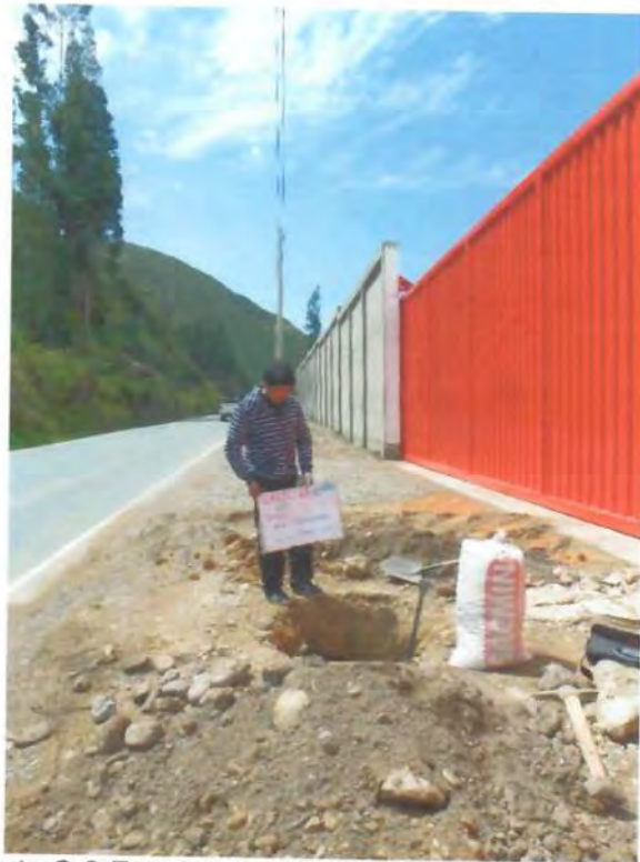
Ubicación Calicata C-2-Exterior. Se observa el material extraído con bolonería.
