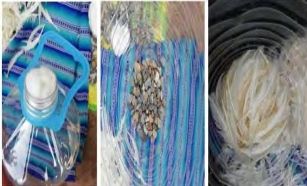
**FOTOGRAFIA 4:** Los iniciaron el armado de la maqueta, colocando un tapón de algodón en la boquilla de la botella, luego colocaron piedra chancada limpia y después las plumas de pollo limpias.
