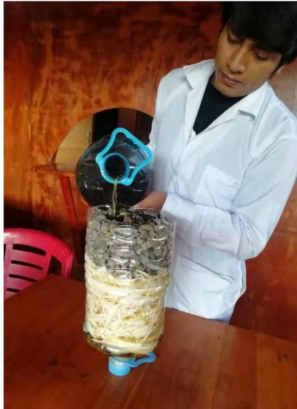
**Figura 16.** *Estudiante añadiendo la muestra de aguas ácida al filtro*
