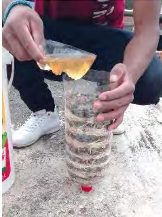
**Figura 19.** *Estudiante añadiendo la muestra de aguas ácida al filtro*
