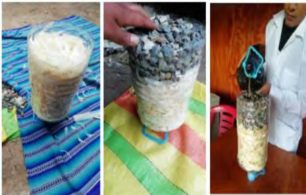
**FOTOGRAFIA 5:** Las plumas de pollo ocuparan los 2/3 del espacio de la botella, que será el medio filtrante, al final se colocó piedra chancada limpia para evitar que las plumas floten al momento de añadir el agua ácida. Una vez finalizado el armado, se inicia con el filtrado del agua ácida (lixiviado de residuos sólidos).
