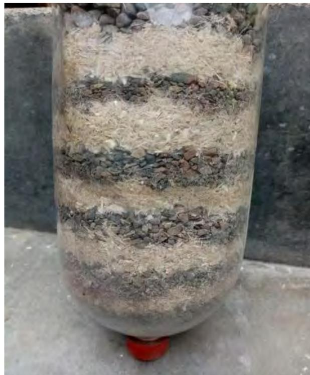
**Figura 25.** Maqueta de plumas cortadas usadas de forma intercalada
