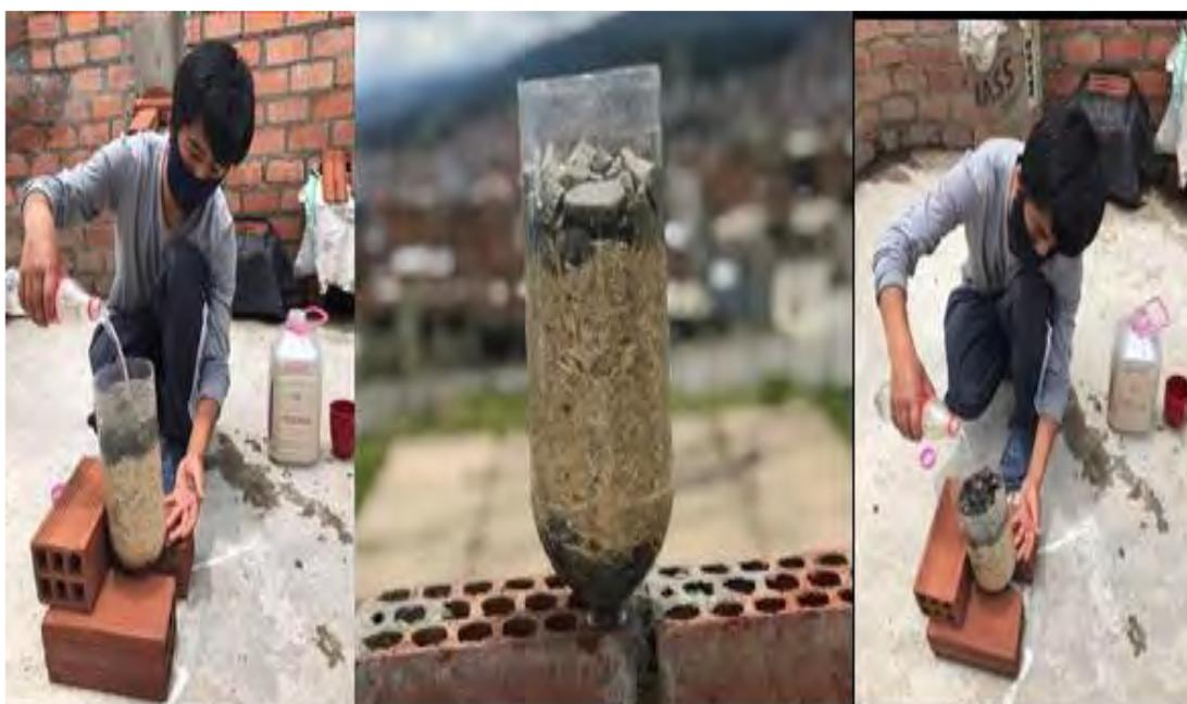
**Figura 23.** Armado de la maqueta con plumas cortadas usadas de manera continua en una sola capa
