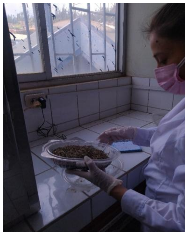
Figura 16. Pesado de las muestras de cobertura vegetal hasta conseguir un peso constante
