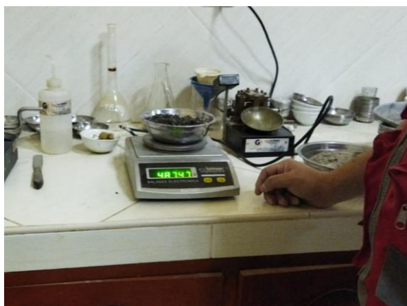
Foto 17: pesado de muestras post secado
