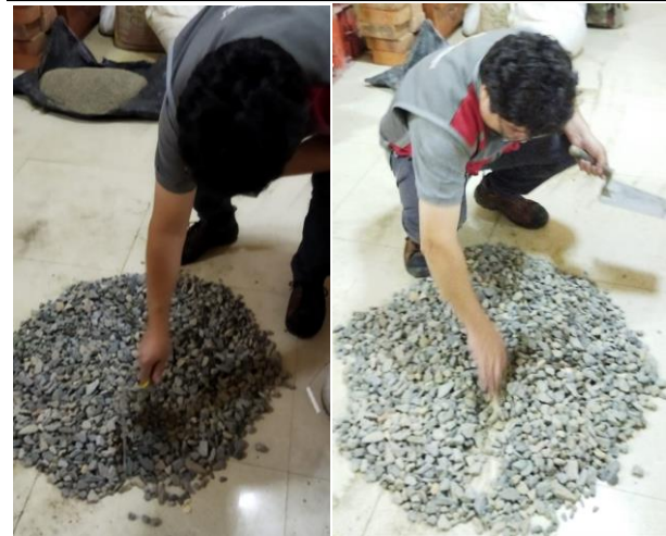
Foto 10: Cuarteo de agregado grueso en laboratorio.
