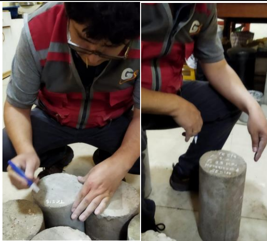
Foto 57: Contabilización de especímenes postdesencofrado
