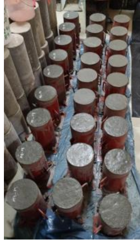
Foto 55: moldeo de briquetas de concreto.
