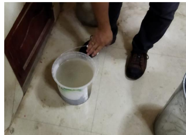
Foto 36: inmersión de agregado grueso
