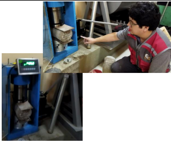
Foto 91: Verificación de rotura diametral
