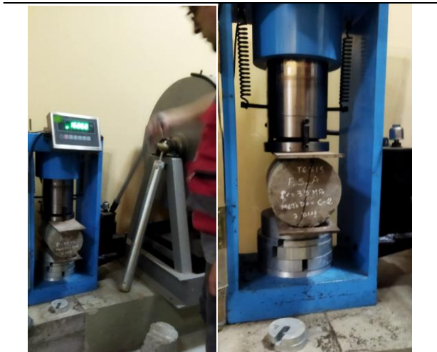
Foto 90: rotura de espécimen curado por inmersión
