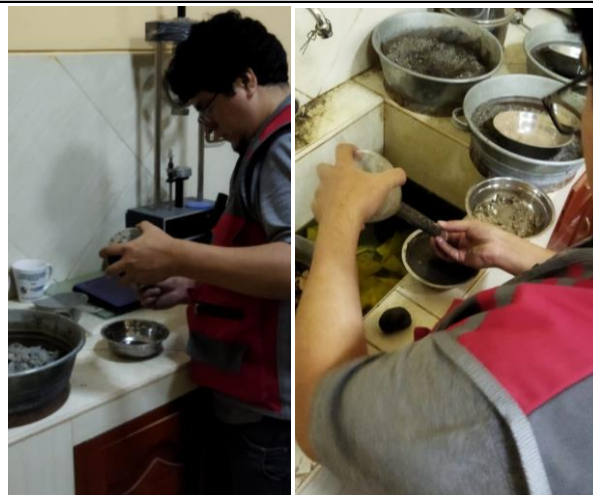
Foto 27: extracción de agreg. fino de fiola.
