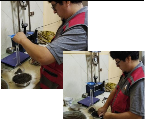
Foto 21: Llenado de agregado fino en fiola
