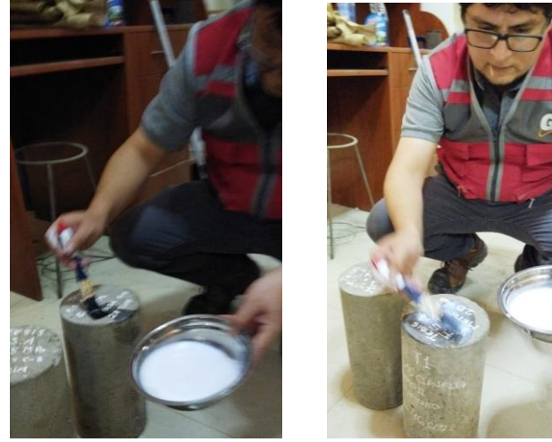
Foto 68: aplicación de aditivo membranal.
