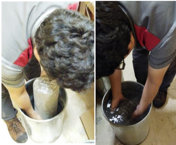
Foto 63: Curado por inmersión (en agua sumergido).
