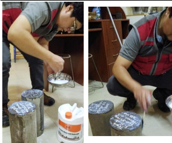
Foto 71: preparación de especímenes con curado diario
