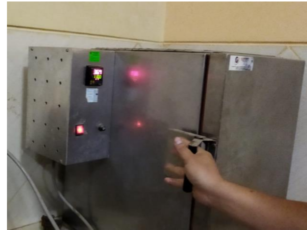
Foto 32: verificación de temperatura de horno.
