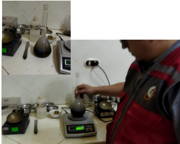
Foto 25: pesado de fiola y muestra de agreg. fino
