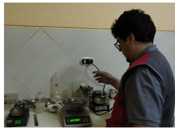
Foto 18: pesado de muestras post secado
