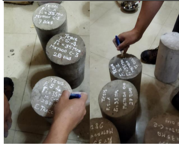
Foto 60: Escritación de datos en especímenes de concreto
