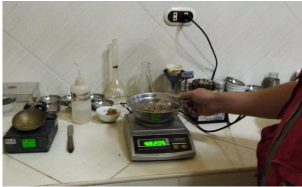
Foto 19: Pesado de muestras posterior al secado
