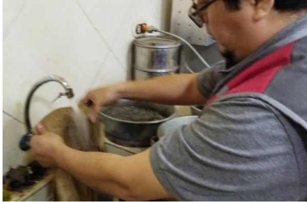
Foto 73: preparación de curado con mantas húmedas
