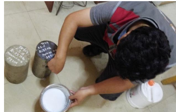
Foto 70: aplicando membranal con brocha
