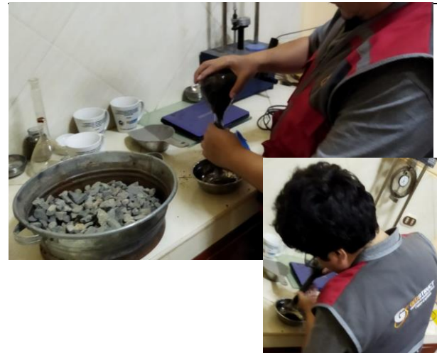
Foto 26: extracción de agreg. fino de fiola.
