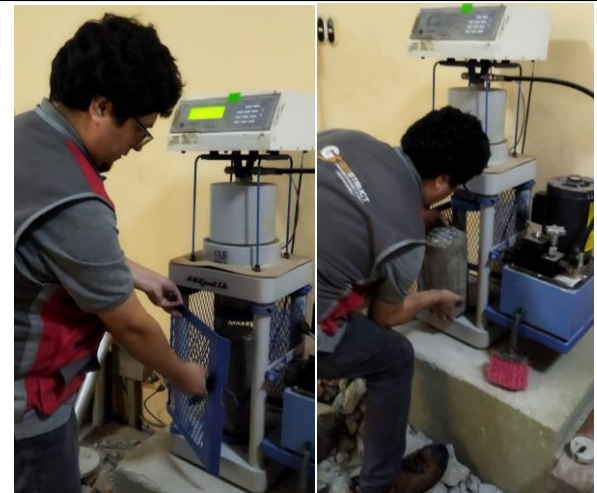
Foto 82: Inicio de ensayo a la compresión del concreto.
