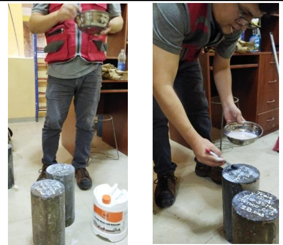
Foto 72: curación dependiendo a la edad del espécimen
