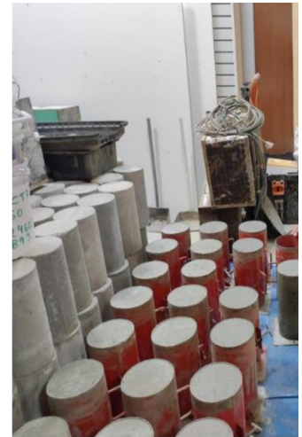
Foto 56: moldeo de especímenes de concreto para ensayos.
