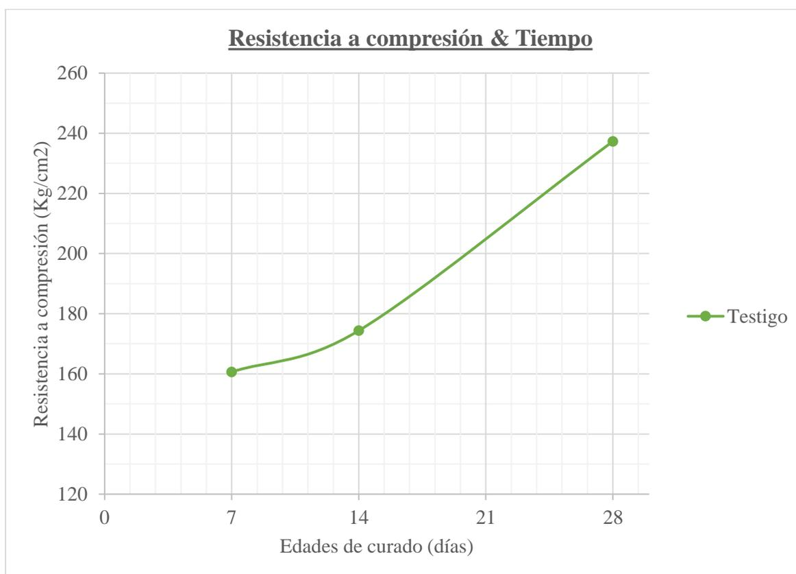
*Nota:* En la figura se presenta los valores de la resistencia a compresión de las probetas testigo del concreto poroso  $f'c=175 \text{ kg/cm}^2$  a las diferentes edades de curado.
