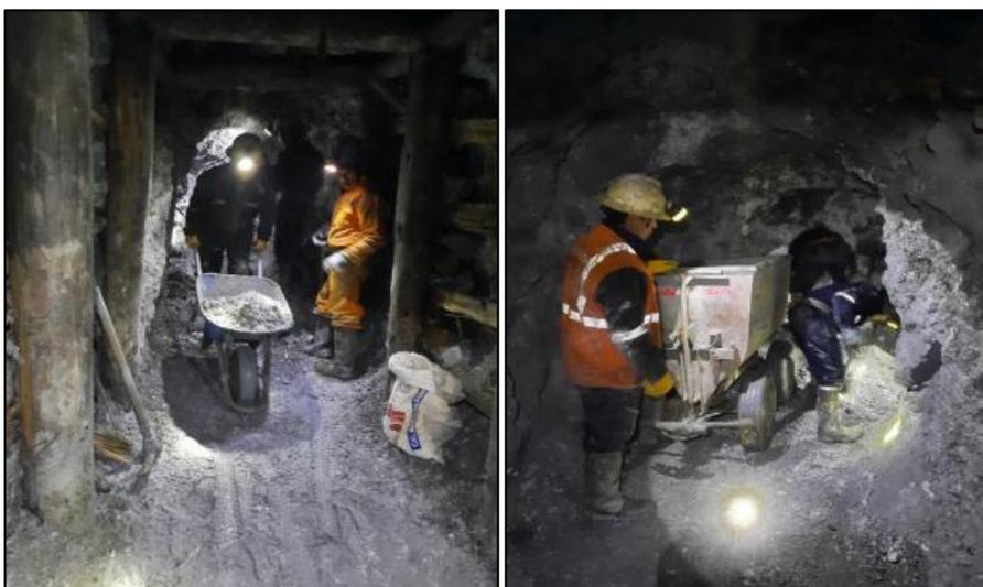
**Fotografía N°05:** Equipo Minidumper descargando mineral en la cancha.
