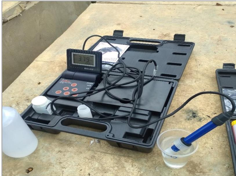
Fotografía 5. Medición de la conductividad del agua residual.
