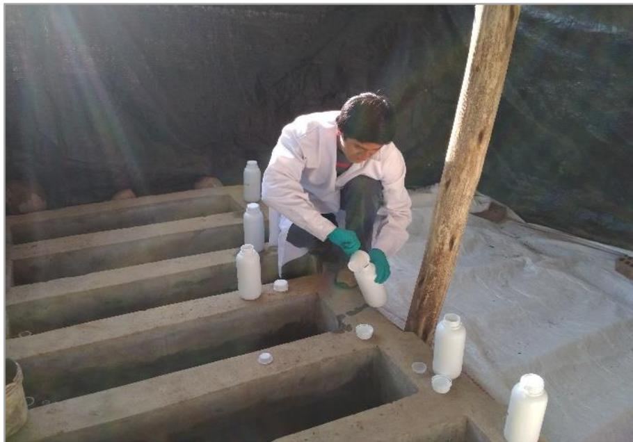
Fotografía 10. Toma de muestras en el afluente y efluente de sedimentadores secundarios.
