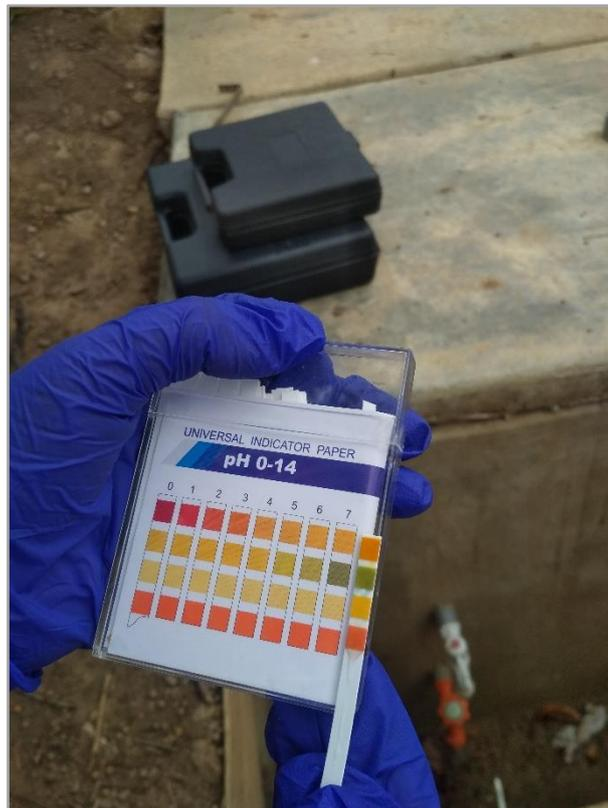
Fotografía 6. Medición del Ph del agua residual.
